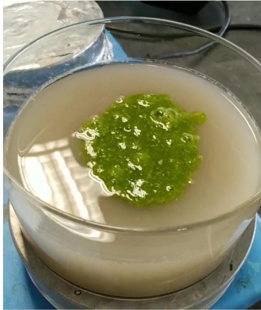
Figura 20-Cladódios liofilizados em pó após a reidratação adicionados a mistura de água e argila (Fonte: O autor)
