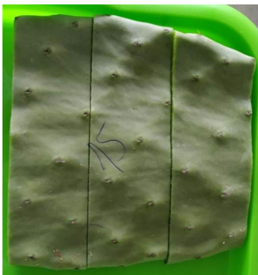
Figura 13-Zona equatorial do cladódio preparada para o teste de textura (Fonte: O autor)
