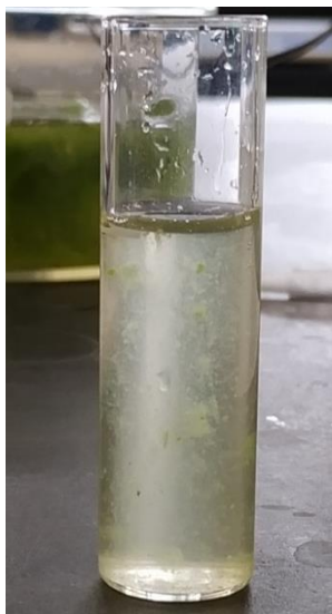
Figura 81-Agregados de mucilagem e argila em suspensão na amostra retirada da tina (Fonte: O autor).
