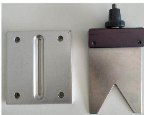
Figura 12-Sonda de corte utilizada e respetiva base de corte da marca Stable Micro Systems (Fonte: O autor)
