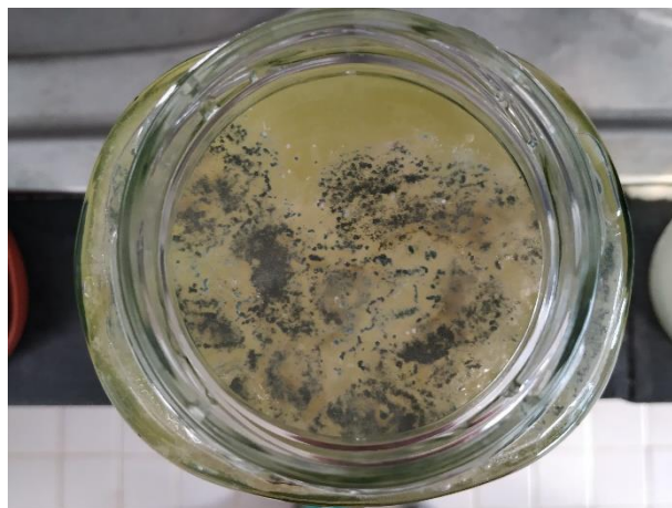
Figura 86-Mucilagem extraída com calor contaminada com fungos após armazenamento (Fonte: O autor).
