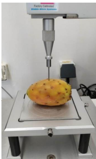
Figura 9-Teste de textura realizado na zona equatorial do fruto (Fonte: O Autor)
