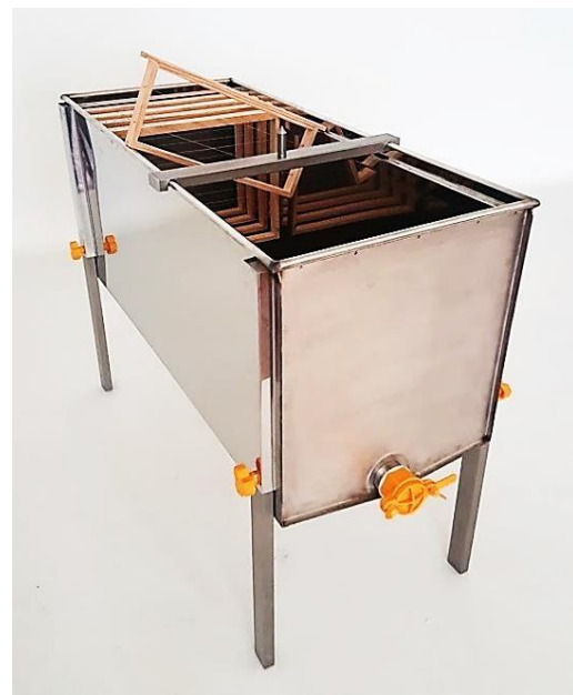
Figura 53- Tina de desoperculação em aço inox para separar cera de
