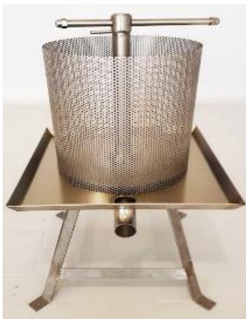
Figura 52- Prensa em aço inox para separação da cera de opérculos do mel
