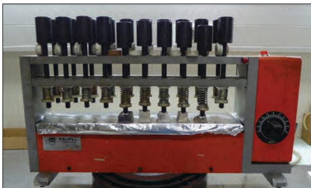
Fig. 2C Colagem das taliscas à lâmina de vidro com resina epóxi.
