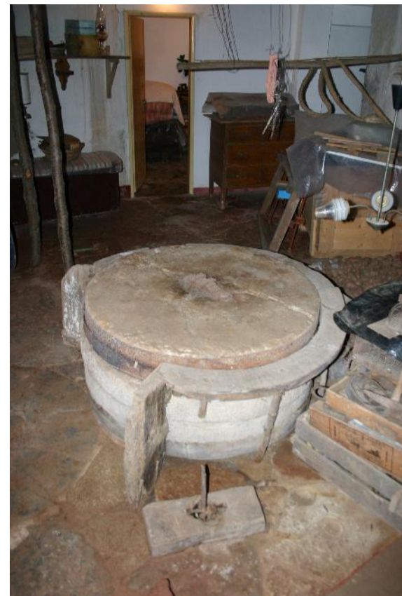
FIG. 38 | Moinho da Ponte de Évora Pouso, mó andadeira, cambeiros e porca. Fonte: Fotografia de Paulo Canas, 2007
