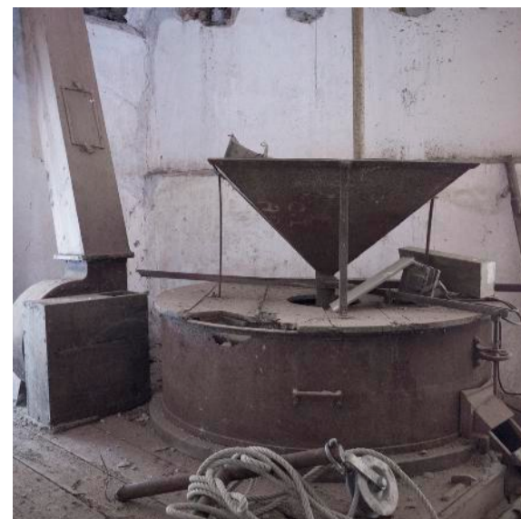
FIG. 97| Moinho do Porto das Lãs. Mecanização do moinho - Tegão, casal de mós, cambeiros e sem-fim. Fonte: Foto do autor, 2017.
