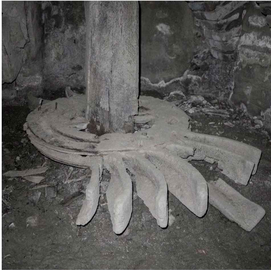
FIG. 120| Moinho do Ananil ou do Bispo - Interior dos caboucos e o que resta do rodizio de penas. Fonte: Fotografia do autor 2017.
