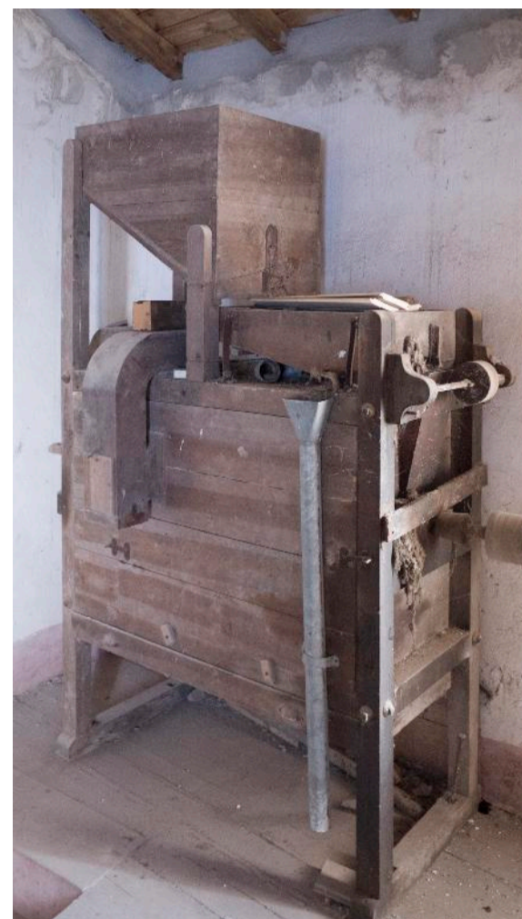
FIG. 98| Moinho do Porto das Lãs. Equipamentos de limpeza da farinha introduzidos depois da mecanização do moinho. Fonte: Fotos do autor, 2017.
