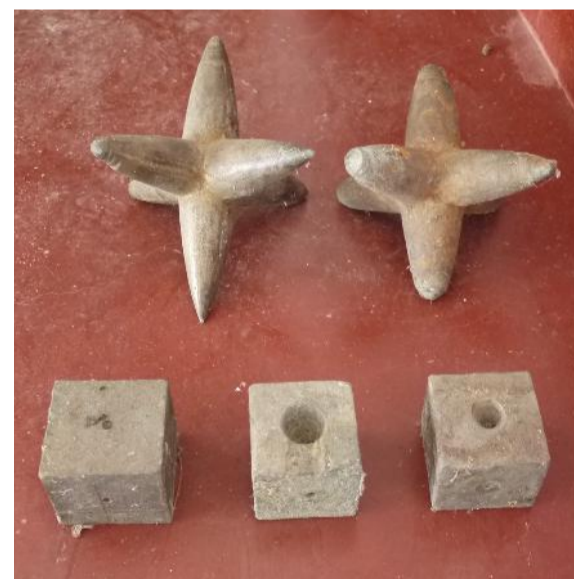
FIG. 39 | Moinho da Ponte de Évora Aguilhão e Relá. Fonte: Fotografia do autor, 2017
