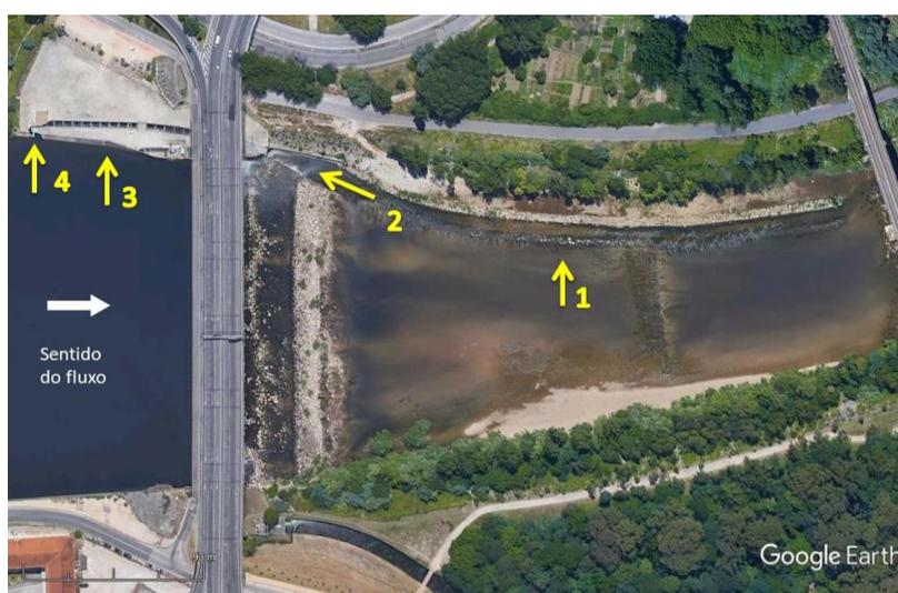
**Figura 7** - Imagem de satélite do Açude-Ponte de Coimbra ilustrando, a jusante o canal de atração (1), a entrada da PPPeixes (2), as bacias sucessivas (3) e, a saída da PPPeixes junto à infraestrutura de apoio à monitorização biológica e hidráulica
