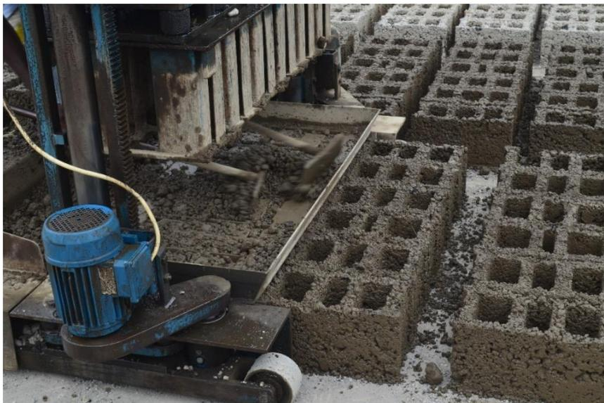
**Figura 22.** Fabricação de blocos de cimento. (Fotografia do dissertando).
