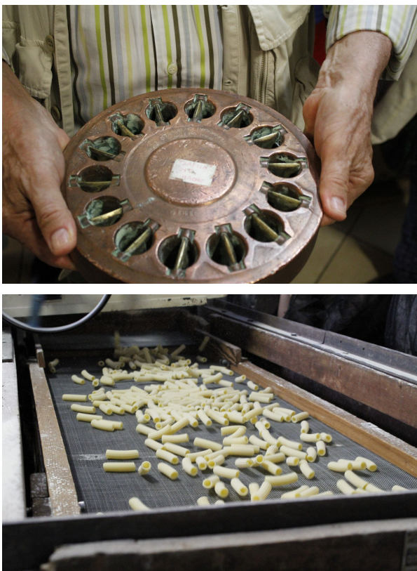
Fig 29 et 30: Filière Muntz et morceaux de pâtes qui vont vers les sécheurs Source: photos Marrone Giulia
