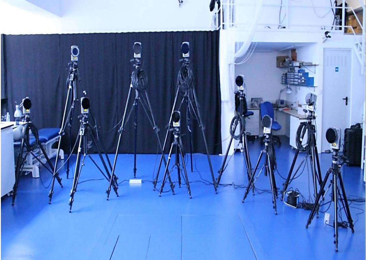
Figura 3.10 - Disposição das câmaras Qualisys no Labiomep
