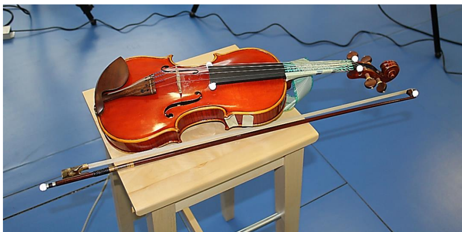
Figura 3.2 - Violino com sensores de pressão acoplados à sua escala e refletores para análise tridimensional
