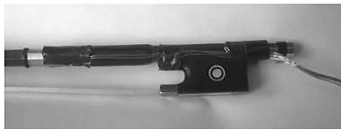
Figura 2.20 - Imagem do arco montado com sensores de pressão.
