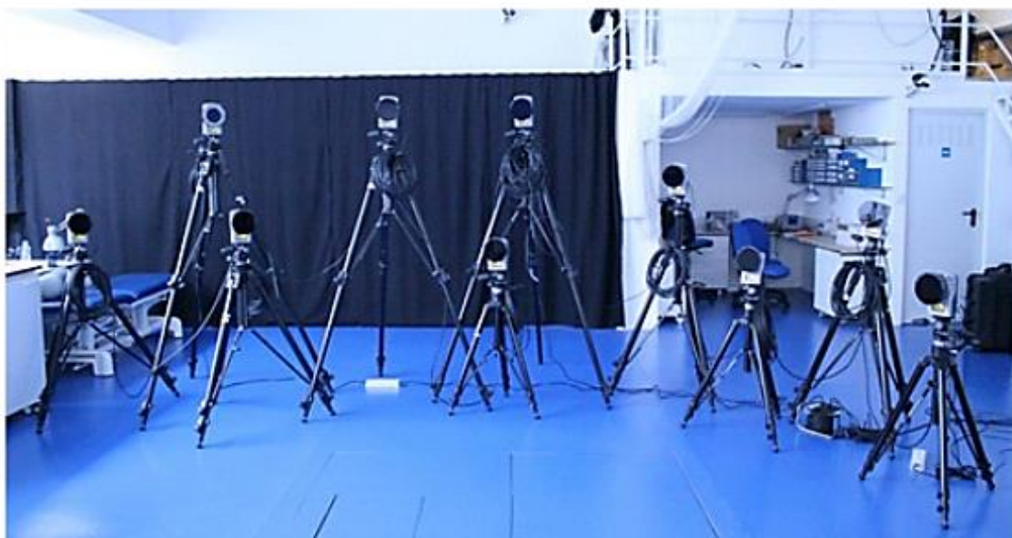
Figura 6 – Disposição das câmaras Qualisys no Labiomepe
