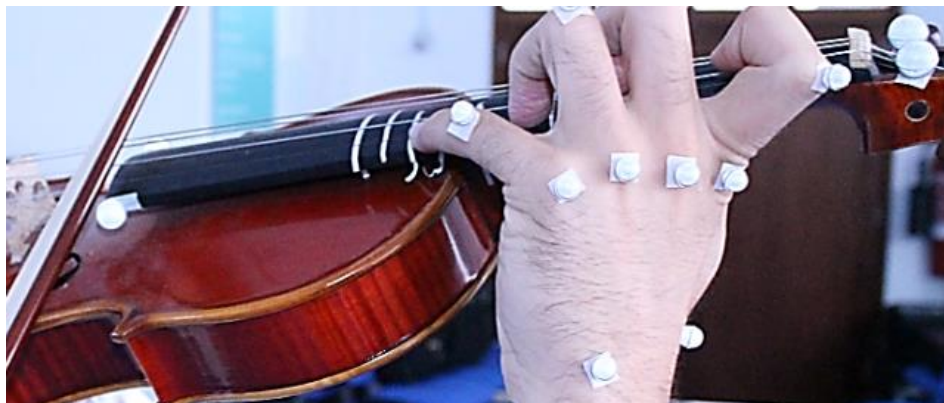
Figura 5.1 - Refletores colocados nas articulações ossiculares da mão, e nas quatro extremidades do ponto do violino.
