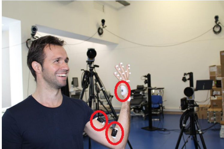
Figura 3.5 - Imagem dos marcadores para análise do movimento a 3D e dos centros inerciais para análise da atividade muscular em EMG 51 , no braço e mão esquerda
