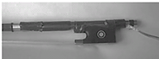
Figura 1 – Imagem do arco montado com sensores de pressão
