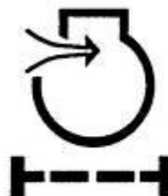
Exemplo de luzes indicadoras de colmatagem do filtro de ar
