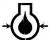
Sinais indicadores de falta de pressão de óleo
