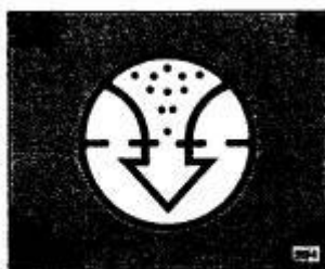
Exemplo de luzes indicadoras de colmatagem do filtro de ar
