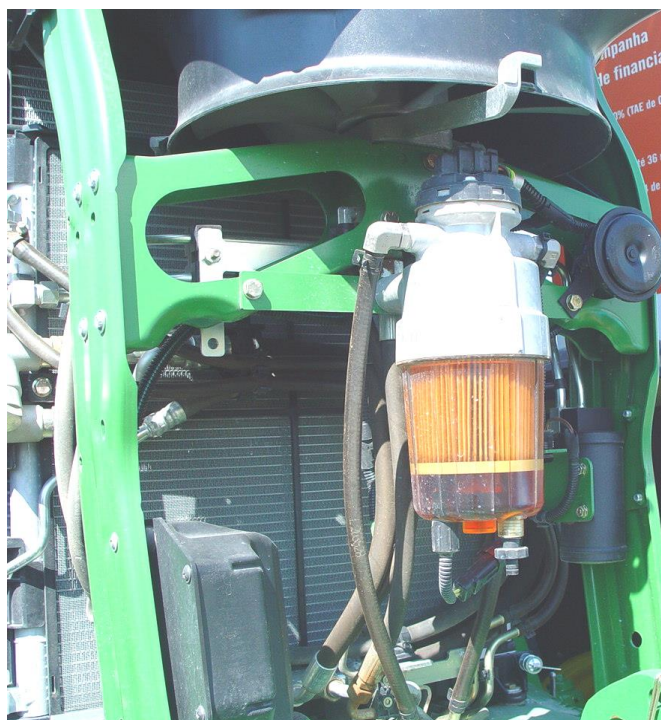
Sistema de filtragem de combustível e separação de água num trator John Deere
