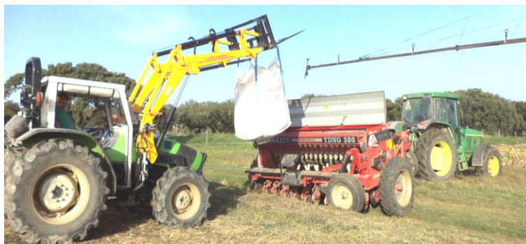
Semeador mecânico de fluxo contínuo. Sementeira directa na Herdade das Lages Grandes (2014)
