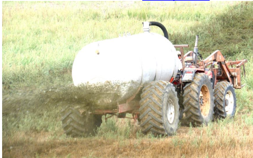
Semi-reboque para distribuir estrumes líquidos (Herdade dos Padres 2014)
