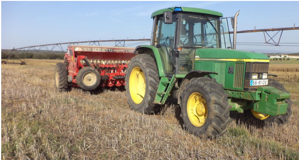
Semeador mecânico de fluxo contínuo. Sementeira directa na Herdade das Lages Grandes (2014)
