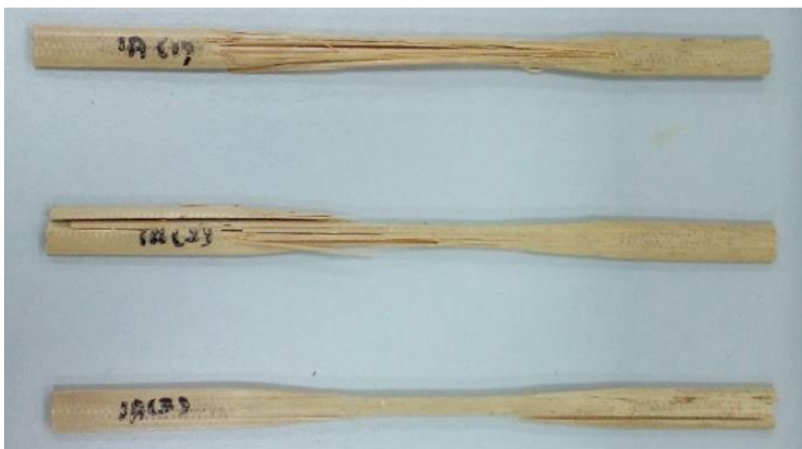
Figura 32 Ejemplo de fallas presentadas en el bambú por esfuerzos a tracción
