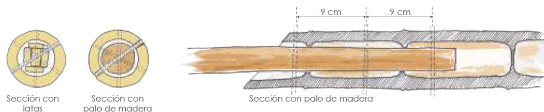
Figura 132 Prolongamiento longitudinal del Bambú en La Ceiba
