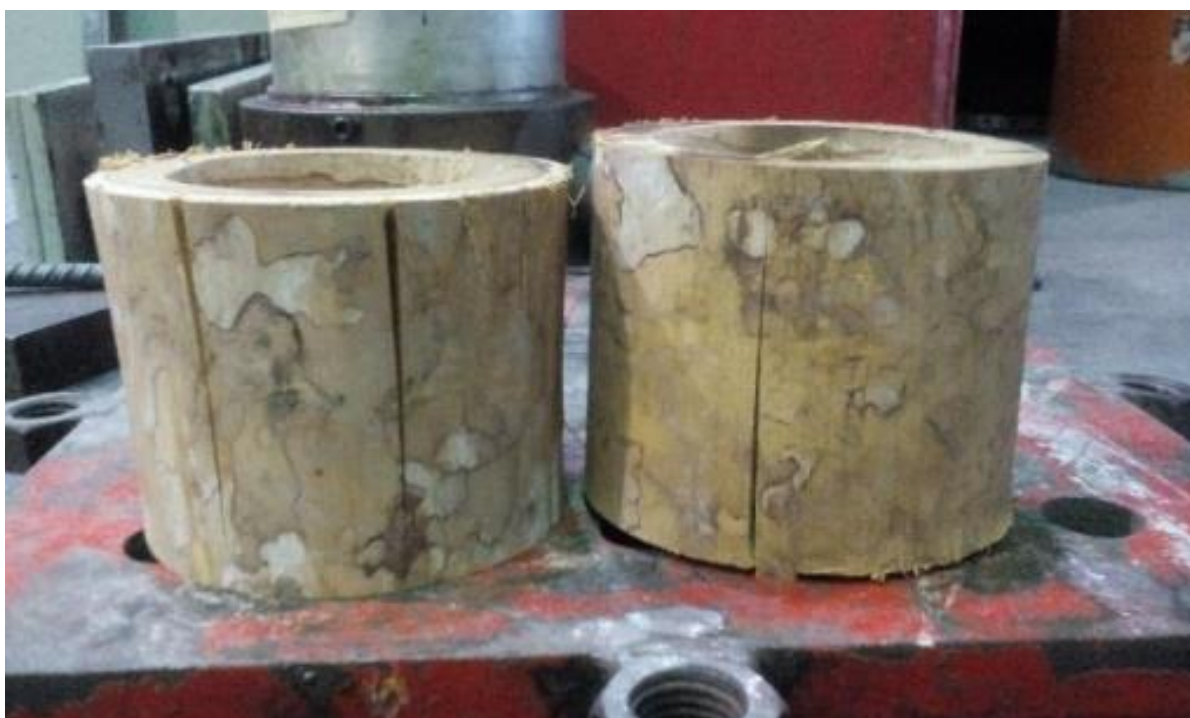
Figura 31 Ejemplo de fallas presentadas en el bambú por esfuerzos a compresión
