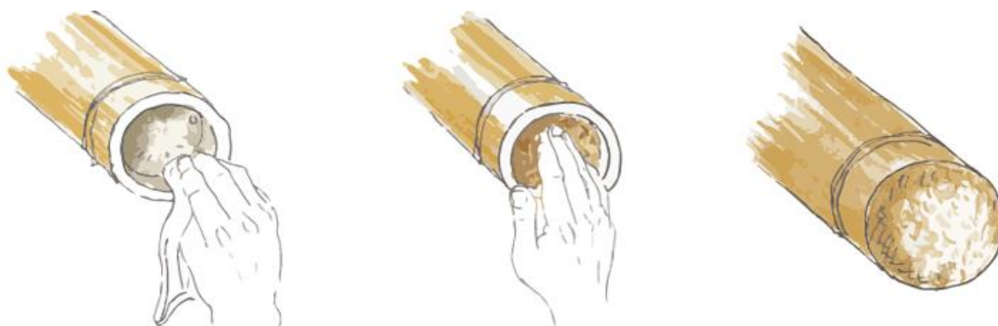
Figura 141 Sellante de aserrín para los tallos de bambú en los dormitorios de La Ceiba
