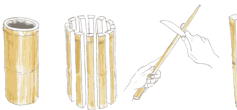
Figura 80 Obtención de pasadores de bambú utilizando un cuchillo
