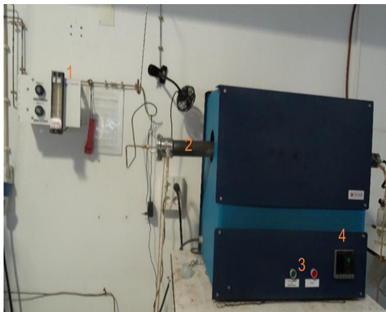
Figura 2.1- Instalação utilizada durante a produção de carvões ativados onde se encontra destacado o forno horizontal, da Thermolab modelo TH. 1- fluoxímetro/controlador de caudal, 2- tubo interior do forno, 3- botão on/off e 4 - controlador do forno.
