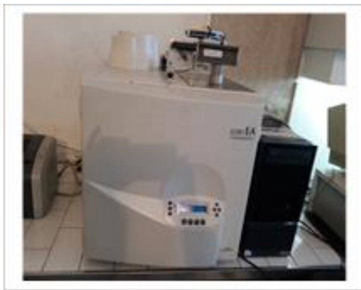
Figura 2.5- Analizador elementar da Eurovector.
