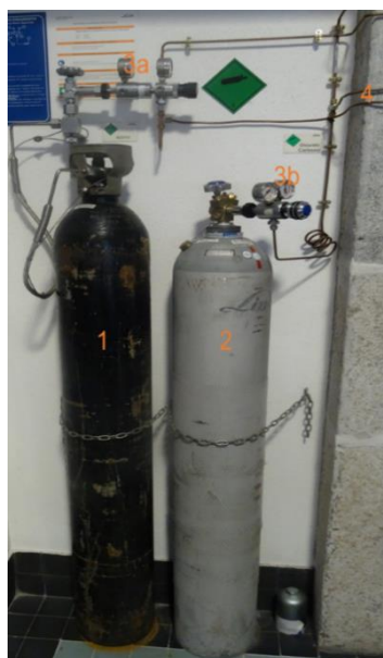
Figura 2.2- Instalação dos gases usados durante a produção dos CA. 1- Garrafa de nitrogénio, 2- Garrafa de dióxido de carbono, (3a e 3b)- Manómetros e 4- Tubagem de ligação entre as garrafas e o forno.
