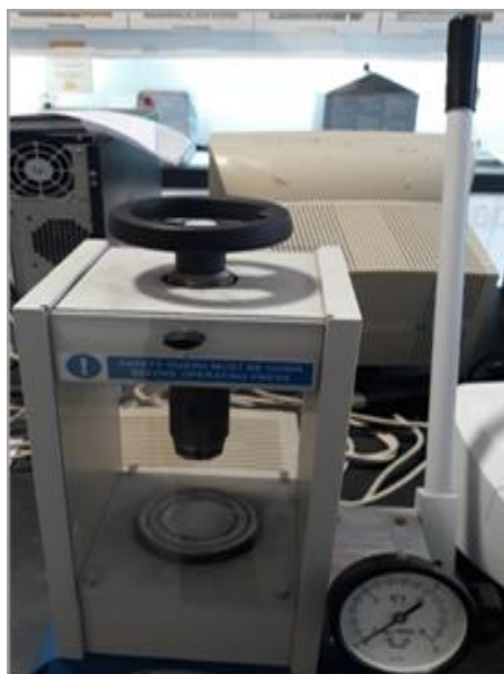
Figura 2.7- Prensa utilizada na preparação das pastilhas de KBr e CA.
