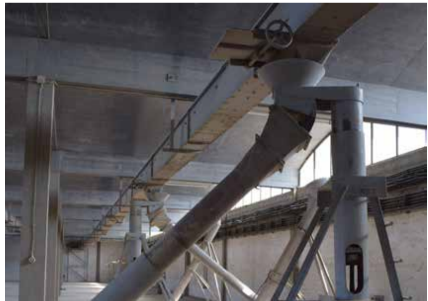
fig.224 Pormenor dos mecanismos de transporte do cereal, fotografia do autor, 2017.
