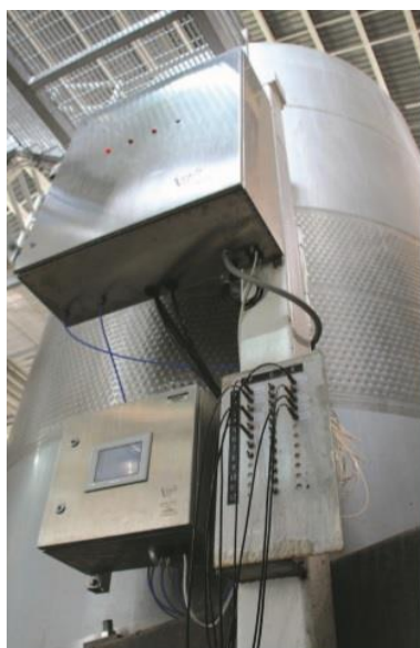
Figura 6. Aspecto de um equipamento de MOx acoplado a cuba de inox Fonte: Phillips (2009).
