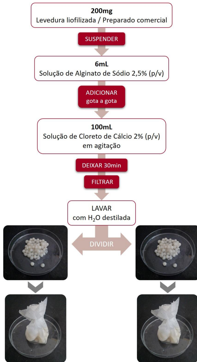
Figura 11. Imobilização de leveduras em alginato de cálcio.
