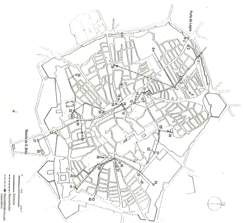
Fig. 26 – Proposta do traçado urbano da rede hidráulica do Aqueduto da Água da Prata, reconstituição sobre planta de finais do séc. XIX.
