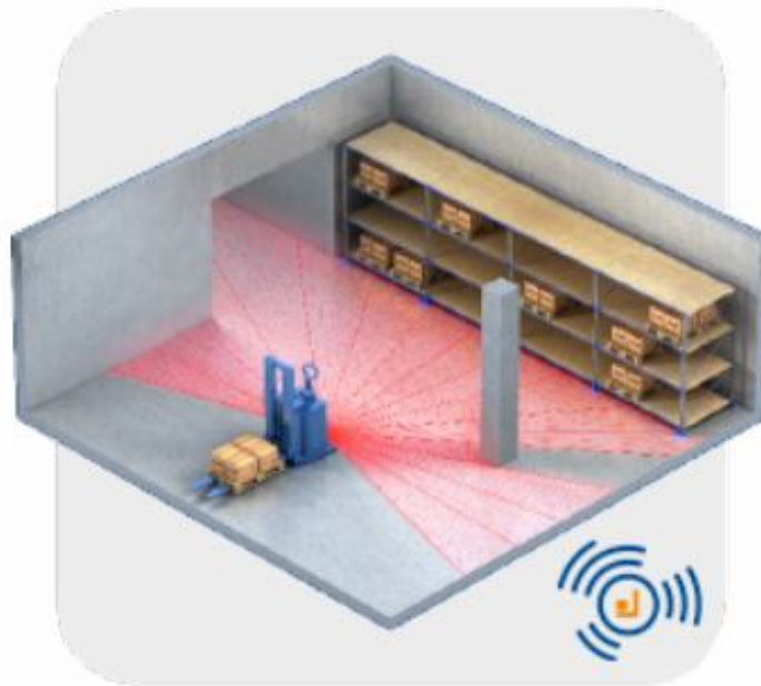
Fig. 6.4 - Navegação por contorno - navegação por laser com marcas naturais (NDC Solutions)
