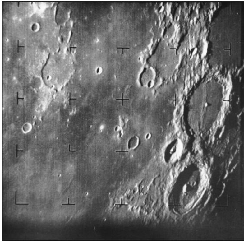
Fig. 2.3 A primeira imagem da Lua captada pela Sonda Ranger 7 em 31 de Julho de 1964 às 9:09 A.M. hora da costa Leste, as marcas na imagem, são marcas de referência usados para correcções geométricas (NASA).
