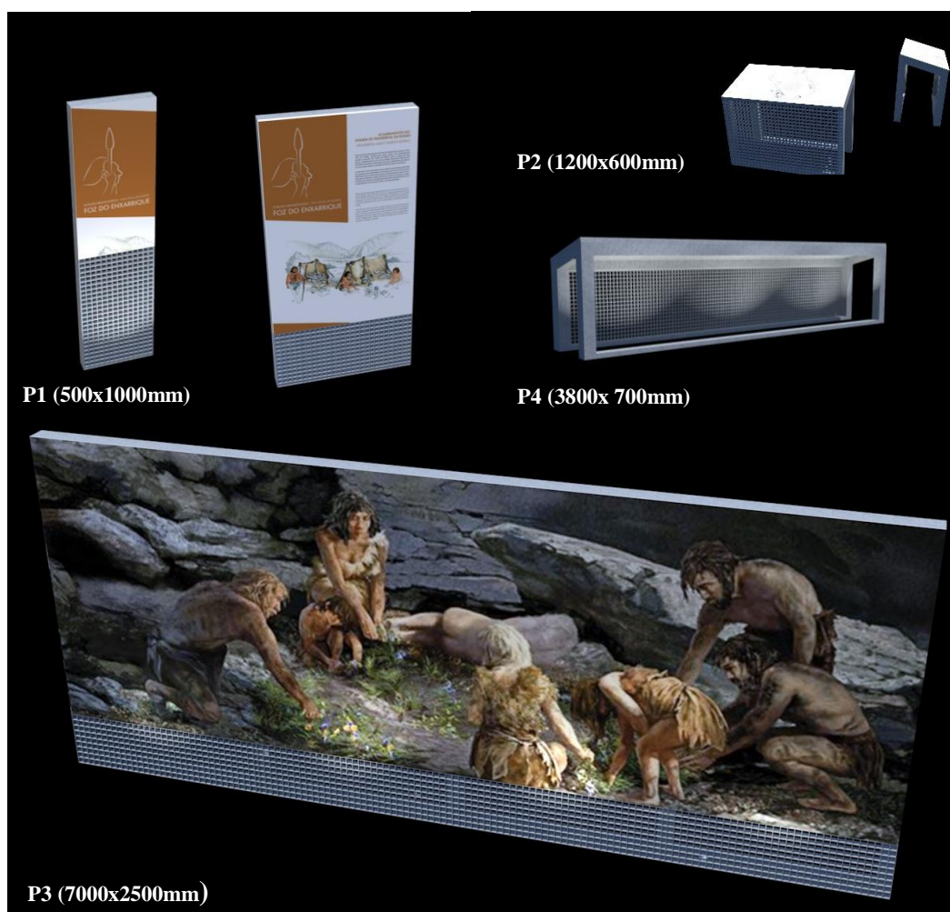
Figura 89 – Estudo desenvolvido para os painéis expositivos da estação arqueológica da Foz de Enxarrique: estrutura em perfis metálicos, grelha metálica galvanizada; chapa metálica e painel de PVC para impressão.
