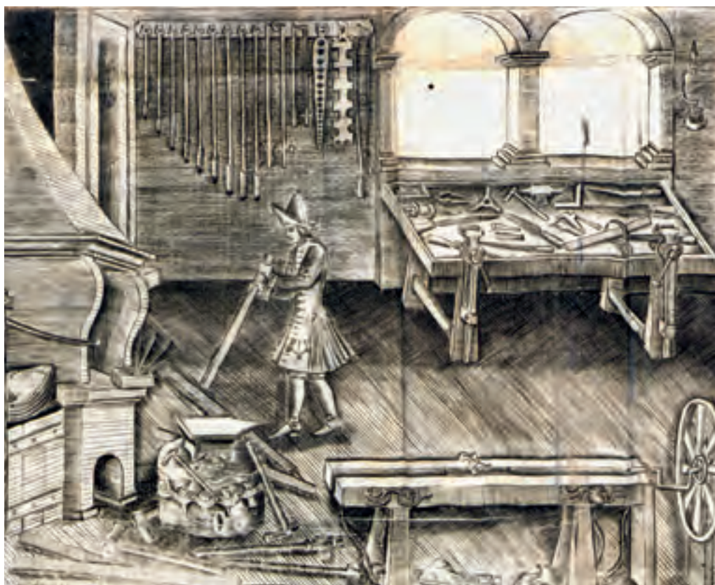
FIG. 2 RODRIGUES 1718 [1191], oficina de espingardeiro com a forja, o torno e a bancada, assim como muitas das ferramentas utilizadas.
