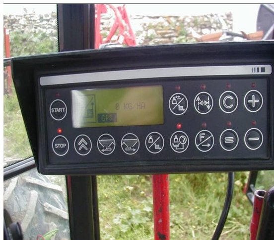
Painel de monitorização e comando (Ferticontrol) do distribuidor centrífugo Vicon Rotaflow RS EDW
