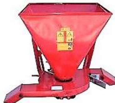
Caixa de repartição para fertilização de duas linhas
