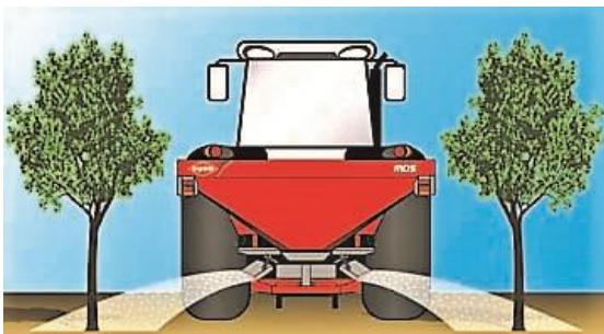
Caixa de repartição para fertilização de duas linhas
