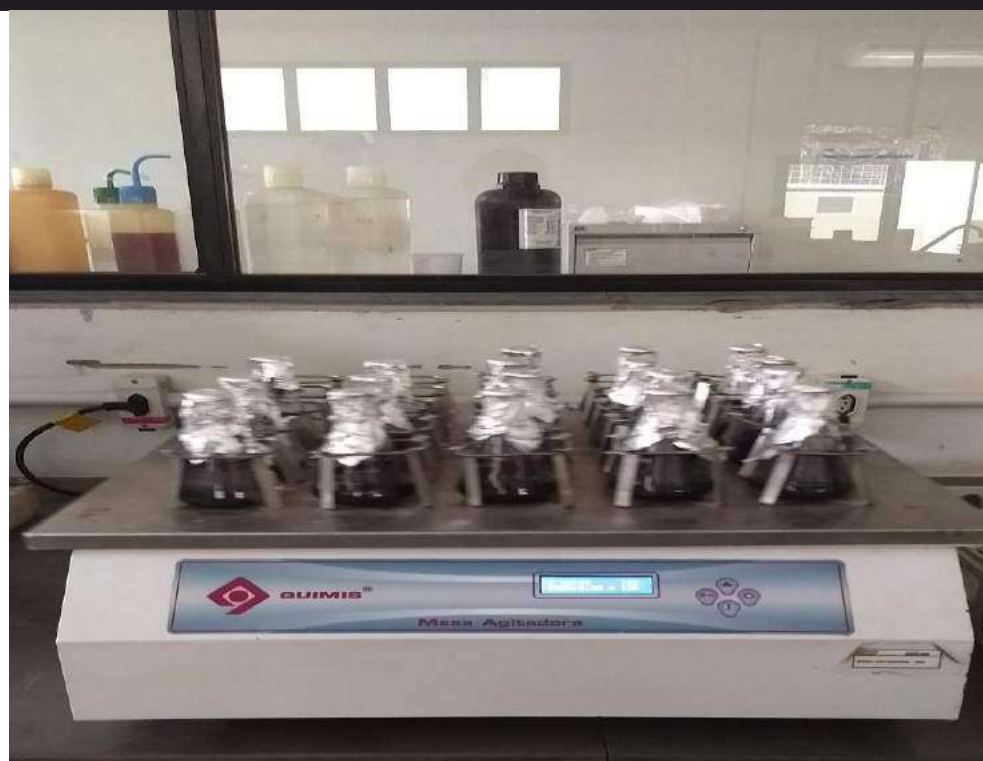
Figura 3 - Amostras na mesa agitadora, ficaram em agitação por 24 horas a uma rotação de 160 rpm.
