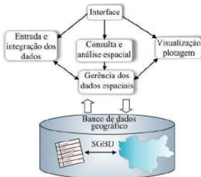
Figura 1. Arquitetura de SIG Fonte: Câmara et al. , 2004, adaptado.
