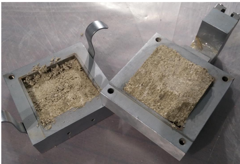
Figura 49 - Fotografia da caixa de corte com a amostra Z4, onde se notam pontos mais claros correspondentes a aglomerados de partículas cortados.
