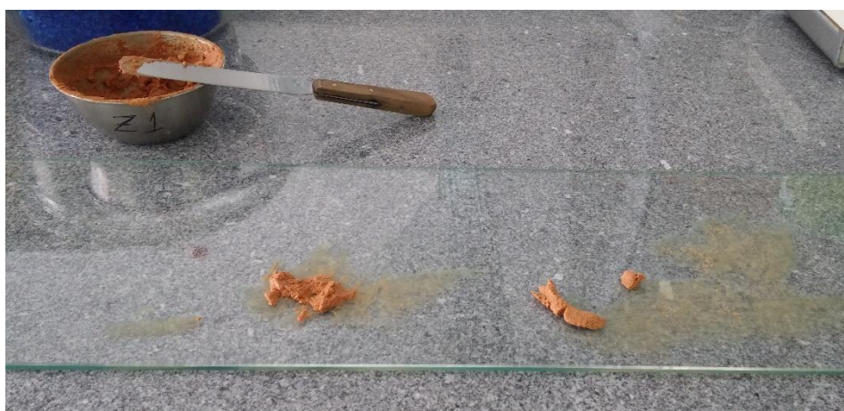
Figura 33 - Pormenor da realização do ensaio do limite de plasticidade.
