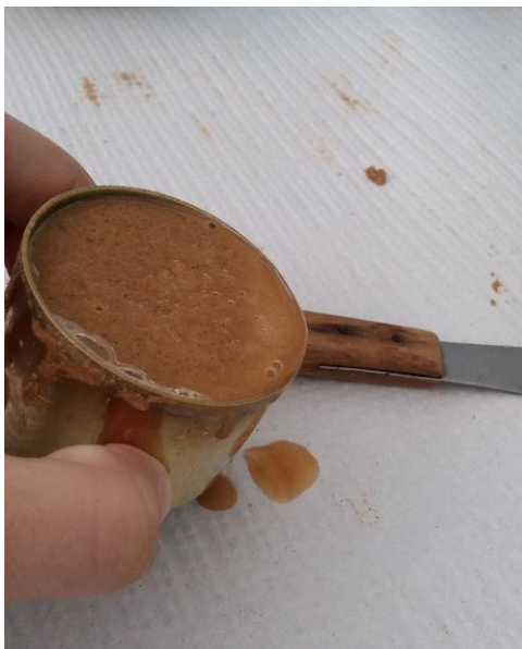
Figura 32 - Pormenor da realização do ensaio de limite de liquidez pelo cone penetrométrico.
