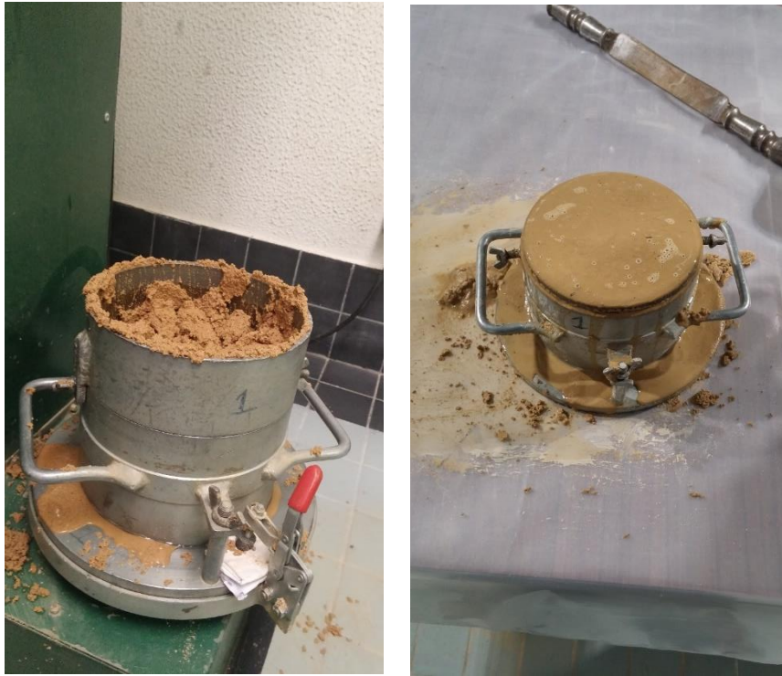
Figura 36 - Pormenores ocorridos ao longo do ensaio de compactação Proctor.
