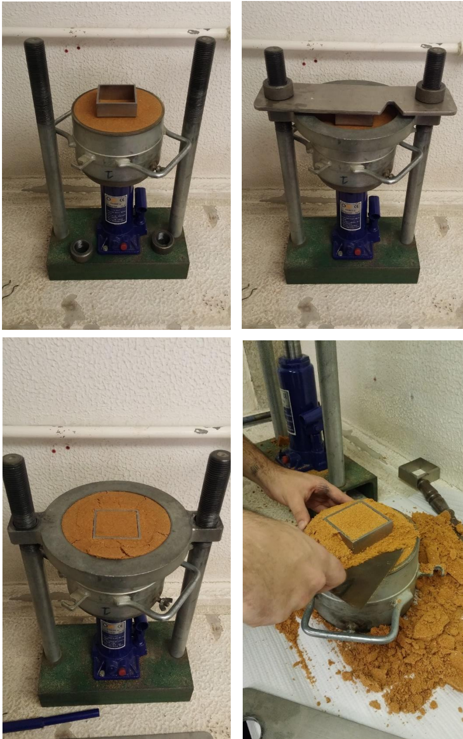
Figura 26 - Processo de extração do provete do solo compactado para o ensaio de corte direto.
