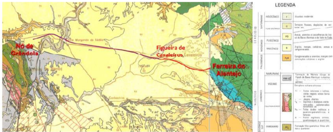
Figura 6 – Excerto da Carta Geológica de Portugal Continental à escala original 1/200 000 com o traçado do lanço B (Nó de Grândola – Ferreira do Alentejo) in Projeto de execução Subconcessão Baixo Alentejo Lanço B: IP8 PE1-Terraplenagem.
