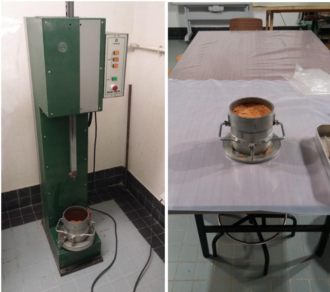
Figura 23 - Fotografia da máquina de compactação e o respetivo molde grande com o solo compactado.
