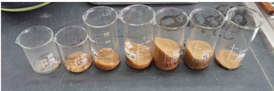
Figura 15 - Frações granulométricas inseridas nos respetivos copos.
