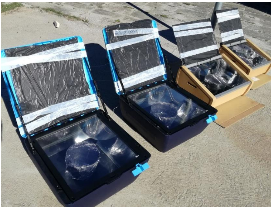
Figura 4.7 – Ensaio com a água e com os refletores dos fornos tapados.
