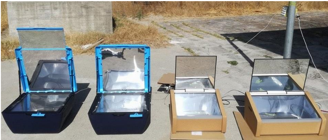
Figura 4.4 – Ensaio de estagnação da placa de absorção do forno.
