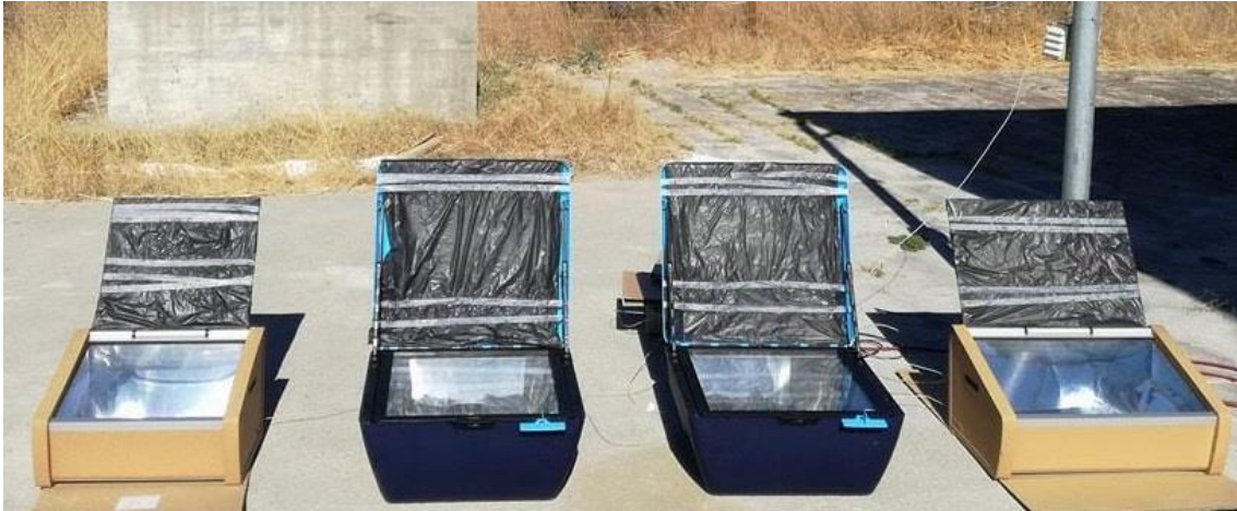
Figura 4.5 - Ensaio de estagnação da placa de absorção do forno, com os espelhos refletores dos fornos tapados.
