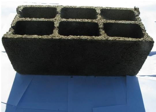
Figura 14 - Bloco de cimento utilizado. Fonte: fotografia.
