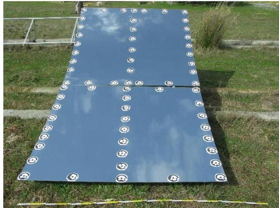
Figura 23 - PTC sistema completo - espelhos concentradores, estrutura metálica, alvos colocados e metro (instrumento de medida).
