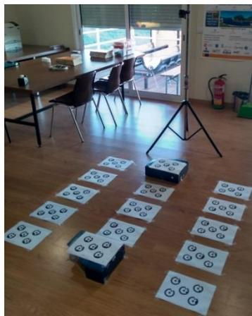
Figura 1 - Calibração da máquina fotográfica utilizada pelo método *multi sheet* com utilização de tripé. Disposição proposta pelo *PhotoModeler UAS*.
