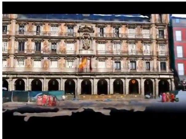
Figura 3 - *Mesh* de fachada de edifício, resultante do método de varrimento. Fonte: <https://www.photomodeler.com>
