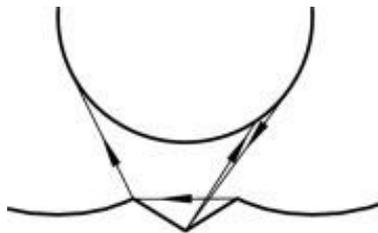
Figura 30 – Esquema de concentrador solar tipo *cpc* com zoom localizado na zona do *v-shape* e tubo recetor. Fonte: <https://www.sciencedirect.com/science/article/pii/S0038092X16301980>
