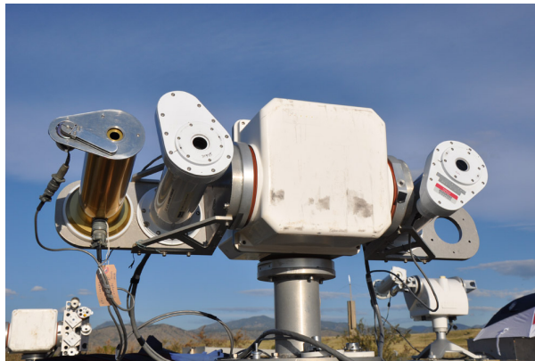
Figura 2.8: Pireliómetros montados em um seguidor solar durante processo de medição da radiação solar direta.
