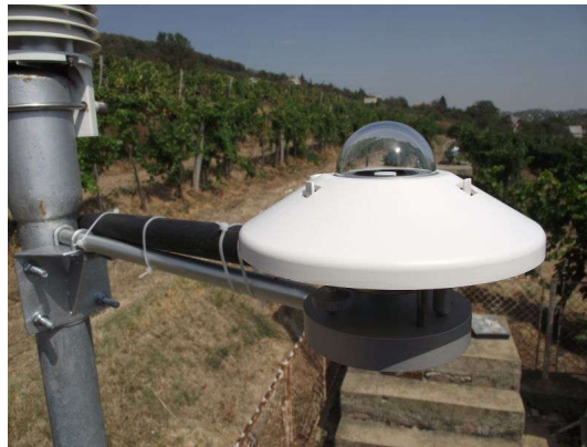
Figura 2.10: Exemplo de piranómetro sem a banda de sombreamento, utilizado para medir a GHI.
