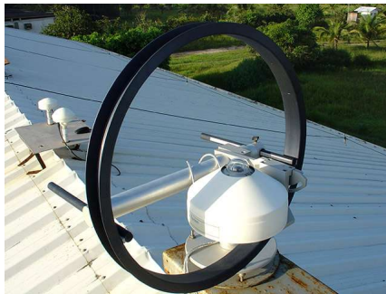
Figura 2.9: Piranómetro sombreado por uma banda para medição da radiação difusa.
