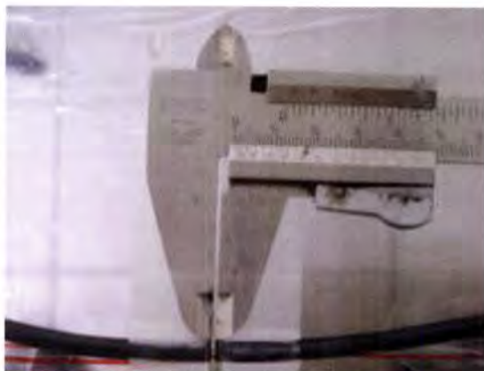
Figura 4.20 – Fenda para a passagem de água
