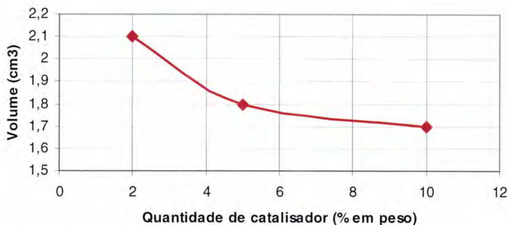
Figura 3.18 – Evolução do volume real da amostra para diferentes quantidades de catalisador
