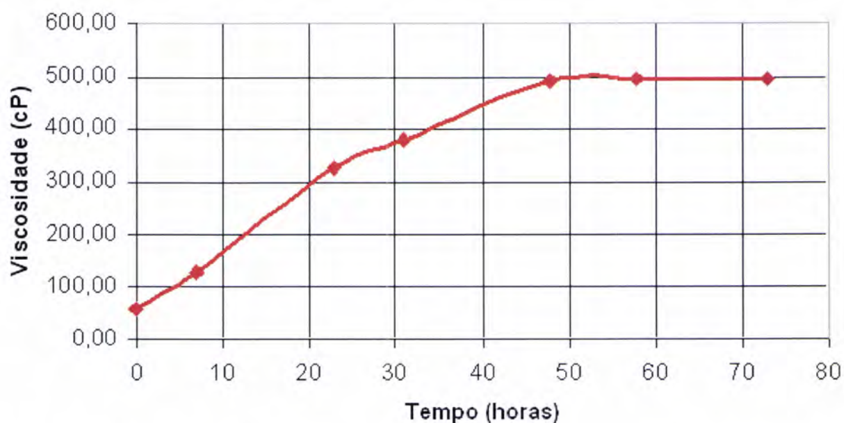
Figura 3.3 – Evolução da viscosidade ao longo do tempo após início da reacção
