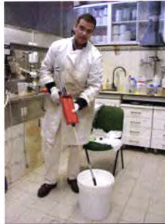
Figura 4.3 – Procedimento de injeção em balde de areia.
