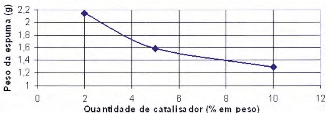
Figura 3.17 – Evolução do peso da amostra cilíndrica de espuma para diferentes quantidades de catalisador
