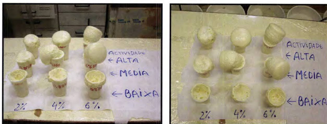
Figura 2.2 – Espumas obtidas com diferentes tensoactivos e diferentes teores, com o prepolímero de referência 8D1000(30)
