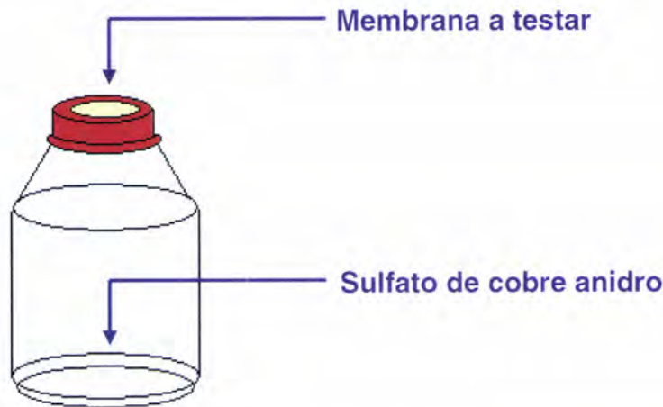
Figura 2.21 – Esquema da montagem utilizada nos testes comparativos de permeabilidade ao ar
