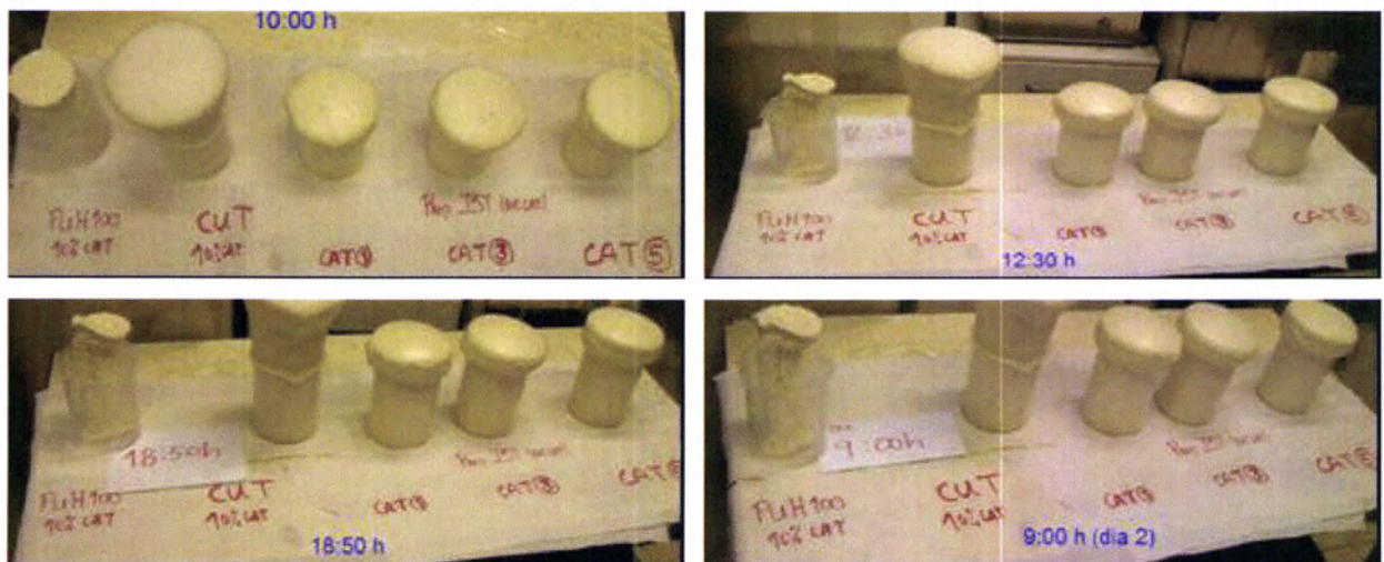
Figura 4.34 – Evolução da retracção, ao longo do tempo, dos prepólímeros ensaiados
