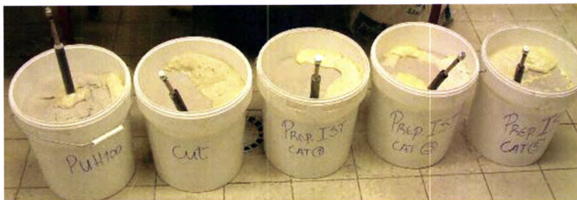
Figura 4.9 – Aspecto dos baldes com areia húmida após injeção
