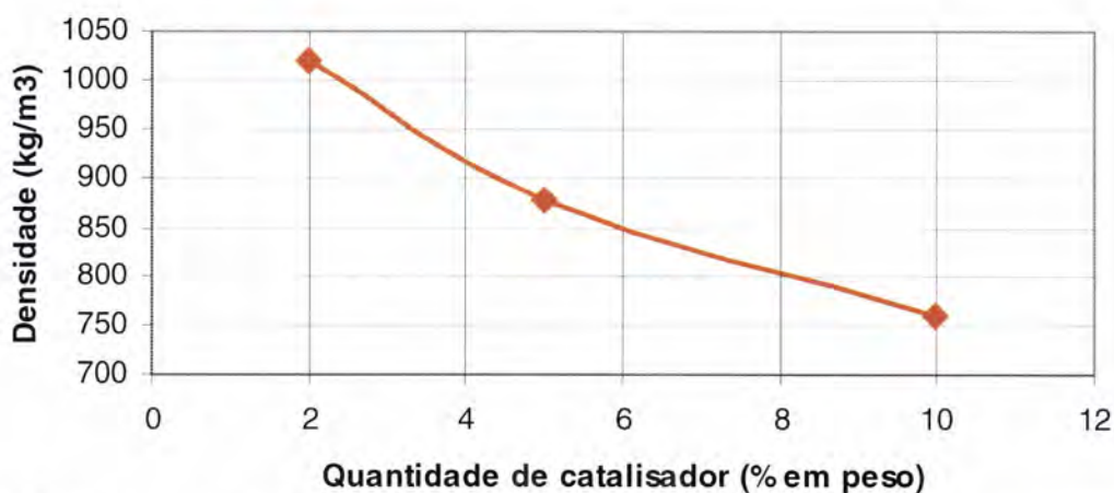
Figura 3.20 - Evolução da densidade real da amostra para diferentes quantidades de catalisador
