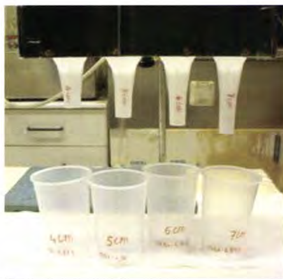
Figura 4.48 – Esquema da montagem experimental utilizada no ensaio comparativo de progressão da espuma.
