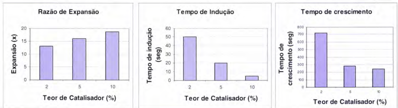
Figura 2.42 – Razão de expansão, tempo de indução e tempo de crescimento das espumas formadas em função da quantidade de catalisador.
