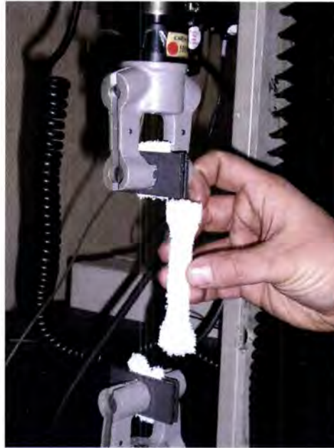
Figura 4.43 – Rompimento dos provetes obtidos com o prepolímero CUT na zona das garras, devido a elevada friabilidade
