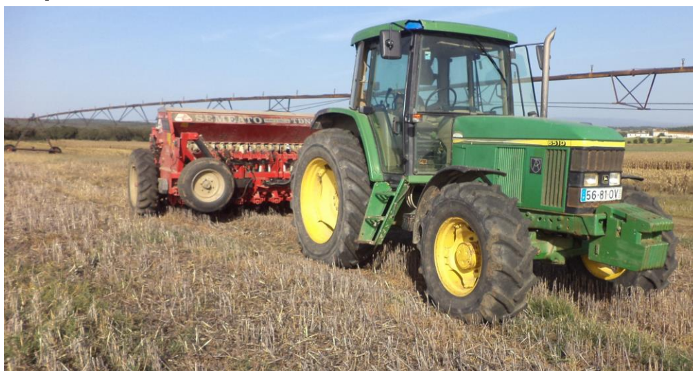
Semeador mecânico de fluxo contínuo. Sementeira directa na Herdade das Lages Grandes (2014)
