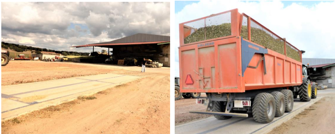
Báscula para pesagem de conjunto tractor e semi-reboque na Herdade do Casão (2014)
