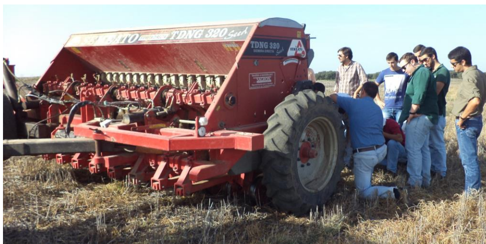
Semeador mecânico de fluxo contínuo. Sementeira directa na Herdade das Lages Grandes (2014)
