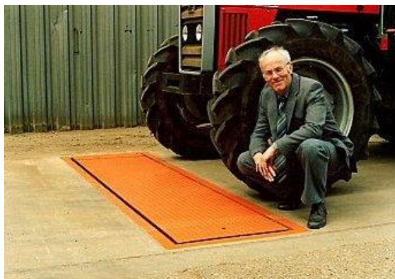
Figura 5 – Balança para a pesagem de eixos
