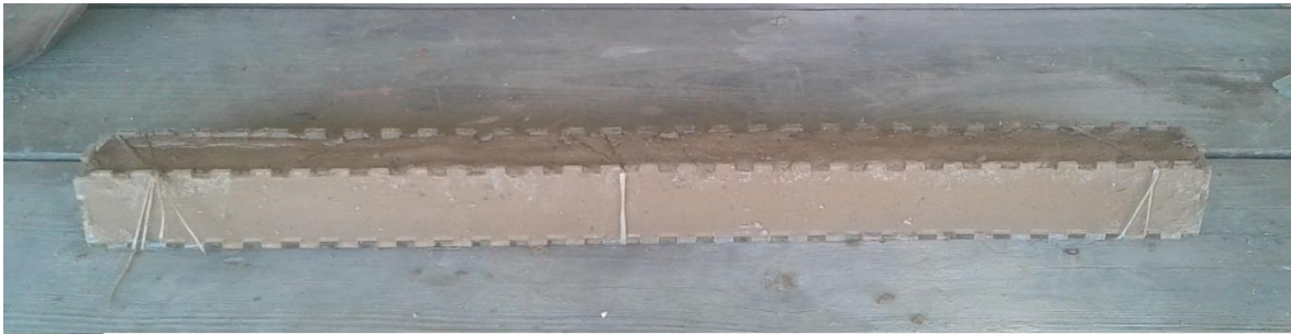
Figura 36 - Teste de retração linear. Exemplo de uma caixa de retração. (Fonte: a autora)
