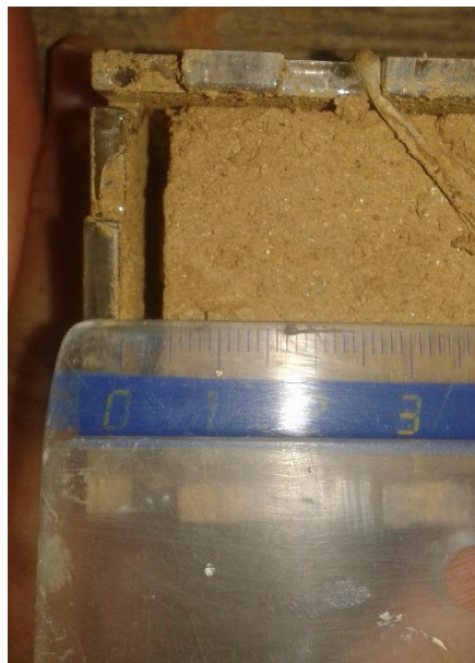
Figura 37 – Medição da retração total do solo. (Fonte: a autora)
