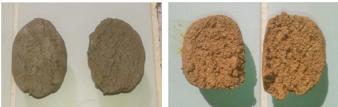
Figura 29 - Caracterização do brilho. Exemplo de 2 tipos de solos distintos. Fonte: a autora
