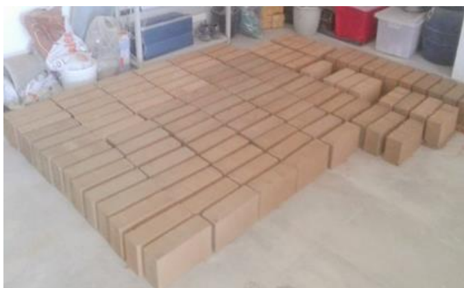
Figura 62 - Disposição dos blocos durante o processo de cura. (Fonte: a autora)
