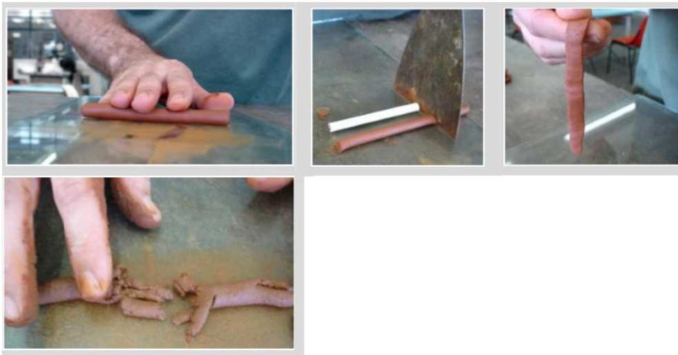
Figura 34 - Teste da fita: formação do "cigarro" e da fita. Imagens superiores: tentativa da formação do "cigarro" e da fita com solo argiloso; Imagem inferior: Tentativa da formação do "cigarro" com solo arenoso. (Fonte: Neves, et al., 2010. p.21)
