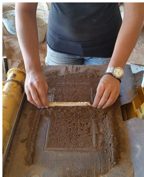
Figura 58 - Nivelamento do material no molde da prensa. (Fonte: a autora)
