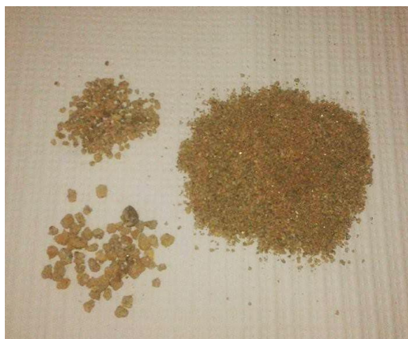
Figura 27 - Caracterização do tamanho das partículas. A olho-nu é possível separar-se o material de maior dimensão do restante.
