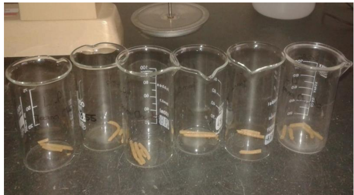
Figura 47 - Resultado de 6 provetes realizados para determinação do limite de plasticidade (Fonte: a autora)
