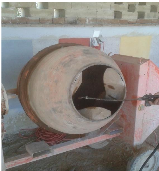
Figura 54 - Adição de água com auxílio de um aspersor. (Fonte: a autora)
