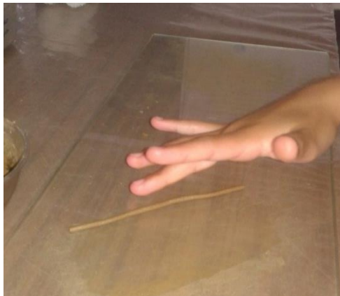
Figura 46 - Realização do ensaio para determinação do limite de plasticidade. (Fonte: a autora)
