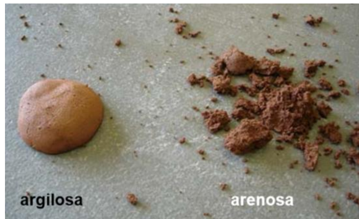
Figura 32 - Teste da queda da bola: aspecto do espalhamento, em função do tipo de solo. (Fonte: Neves, et al., 2010, p.18)
