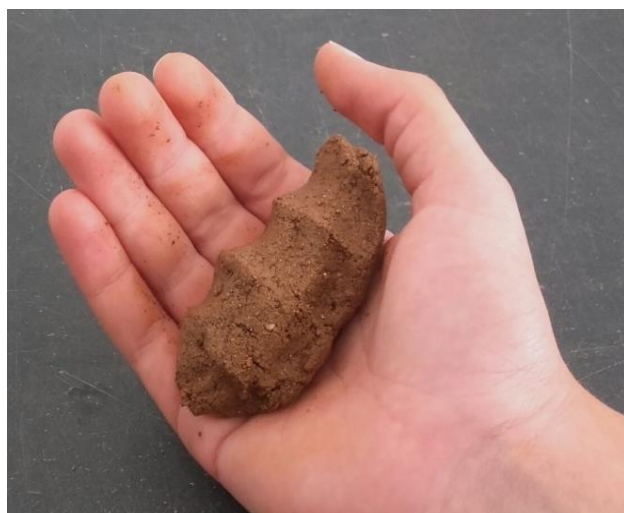
Figura 55 - Forma expedita de se verificar o ponto "ótimo" de adesão do solo. (Fonte: a autora)
