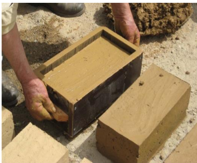
Figura 15 - Blocos de adobe sendo desmoldados. (Fonte: http://www.betaoetaipa.pt/servicos_detail.php?servico=adobe – 13/05/2016)
