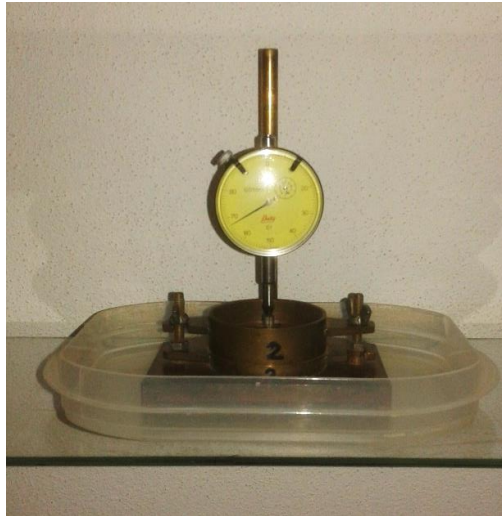
Figura 50 - Aparelho para determinação da expansibilidade do solo.
