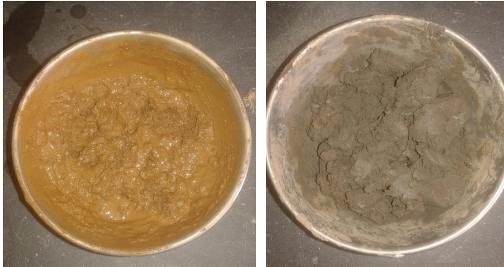
Figura 28 - Caracterização da cor. Exemplo de 2 solos distintos. Fonte: a autora
