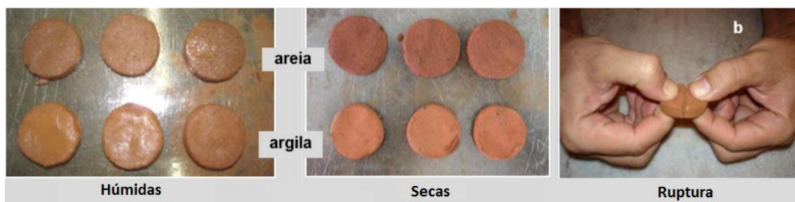
Figura 33 - Teste da resistência seca. (Fonte: Neves, et al., 2010, p.23)
