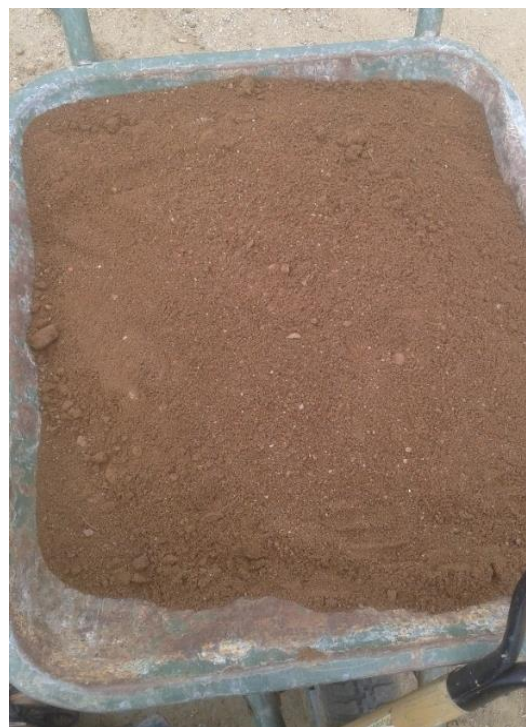
Figura 40 - Solo após ter sido destorroado. (Fonte: a autora)
