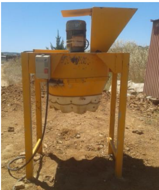
Figura 39 - Moinho de hélices utilizado para o destorroamento do solo. (Fonte: a autora)
