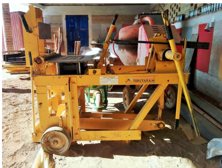
Figura 56 – Prensa utilizada para a produção dos BTC's (Fonte: a autora)
