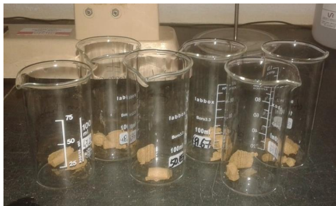
Figura 45 - Resultado de 6 provetes realizados para determinação do limite de liquidez. (Fonte: a autora)
