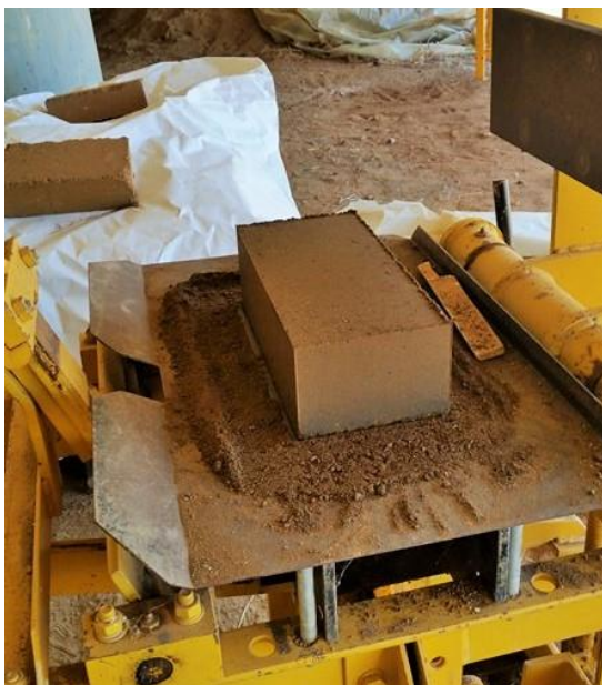
Figura 59 - Bloco acabado de ser prensado. (Fonte: a autora)
