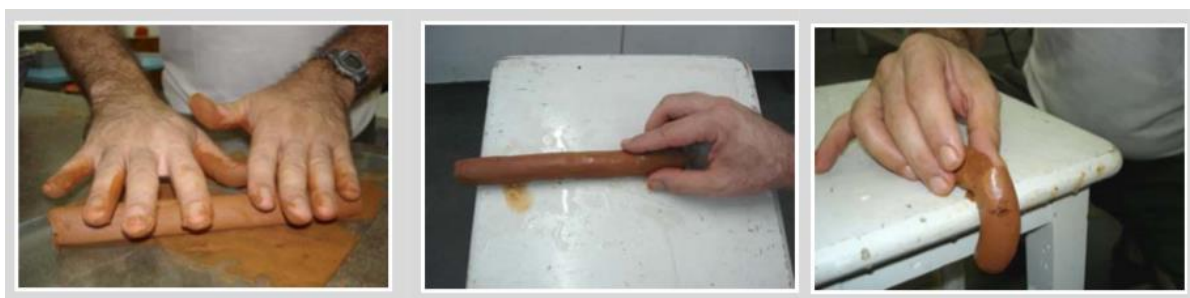
Figura 35 - Teste do rolo: o solo apresentado tem carácter argiloso. (Fonte: Neves, et al., 2010. p.26)
