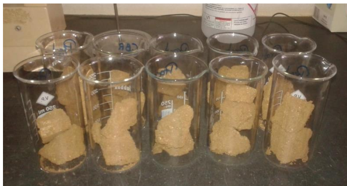
Figura 52 - Resultado de 5 provetes realizados para determinação do teor em água ótimo. (Fonte: a autora)
