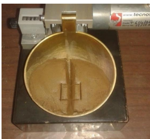
Figura 44 - Concha de Casagrande. Aparelho utilizado para a determinação do limite de liquidez. (Fonte: a autora)
