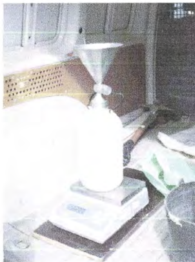
Figura 4.9 – Pesagem da garrafa de areia antes do enchimento do buraco aberto na camada
