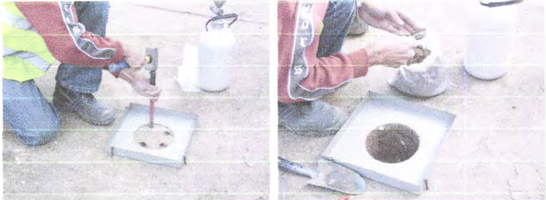
Figura 4.8 – Abertura do buraco na camada, para execução do ensaio da garrafa de areia
