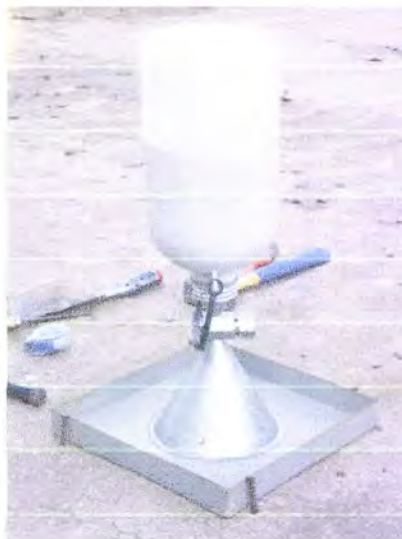
Figura 4.10– Enchimento do furo aberto na camada
