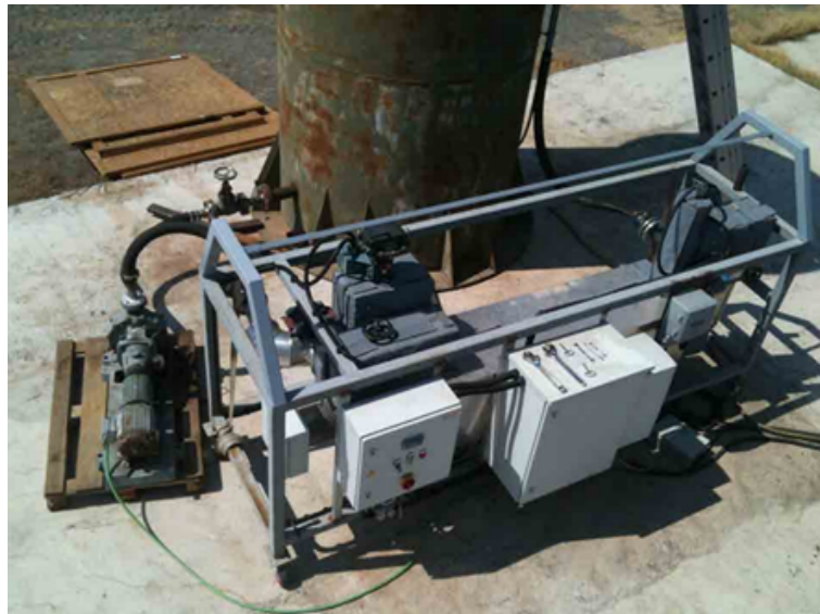
Figura 3.1: Setup do calorímetro para medir C_p da plataforma KONTAS, fonte: [3]
