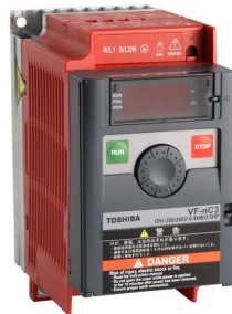
Figura B.8: Variador de Frequência usado no circuito de Óleo
