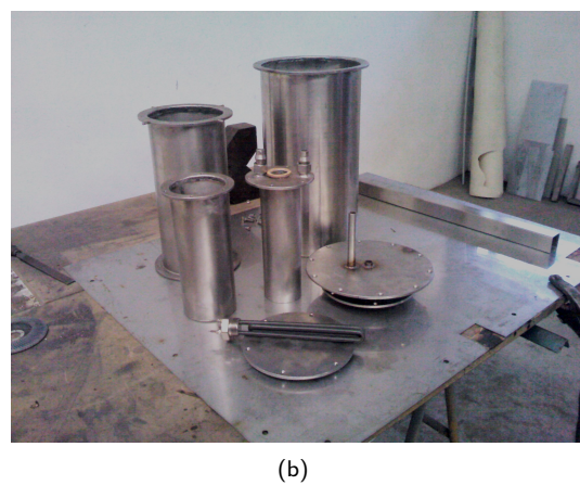
Figura 3.5: (a) Visão em Corte do Calorímetro, com sentido de circulação do fluido, (b) Câmaras por montar do Calorímetro
