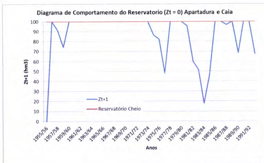
Figura 9.3 - Diagrama de comportamento do reservatório do Pisão para fazer face ao consumo da rega e de abastecimento publico da Apartadura e do Caia.
