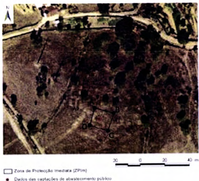
Figura n.ºA.17 – Zona de protecção imediata para a captação de Chão da Velha (adaptada de GGT 2008).
