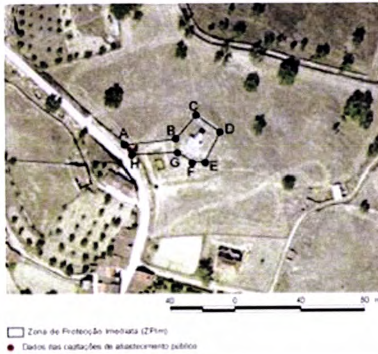
Figura n.ºA.19 – Zona de protecção imediata para a captação de Velada (adaptada de GGT 2008).
