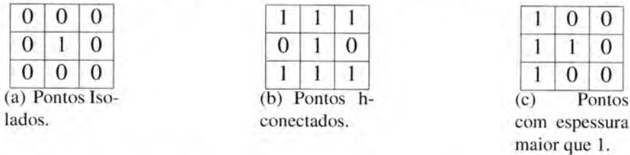
Figura 5.21 Máscaras para remoção de pontos isolados, h -conectados e com espessura maior do que 1.
