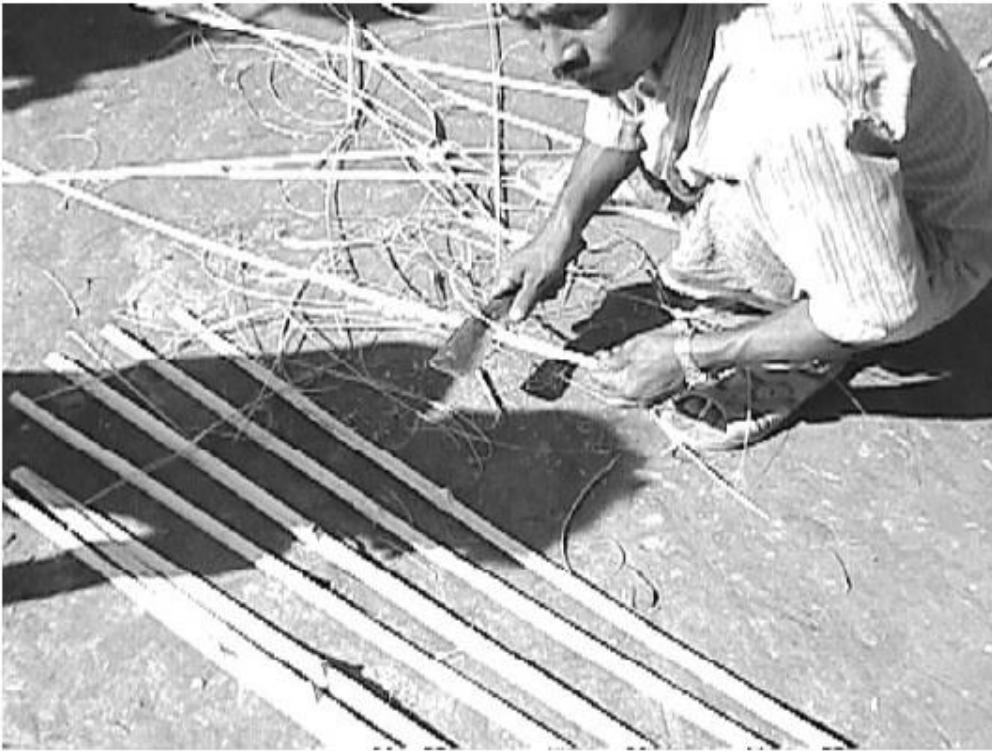
Figura 48: Corte das varas de bambu (Ball e Danert, 1999)
