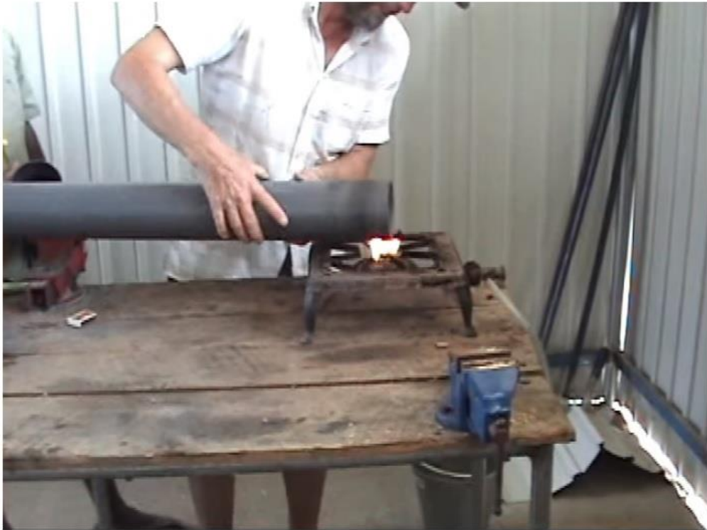
Figura 55: Aquecimento do tubo de forma flexibilizar o PVC (Buchner, 2010a)
