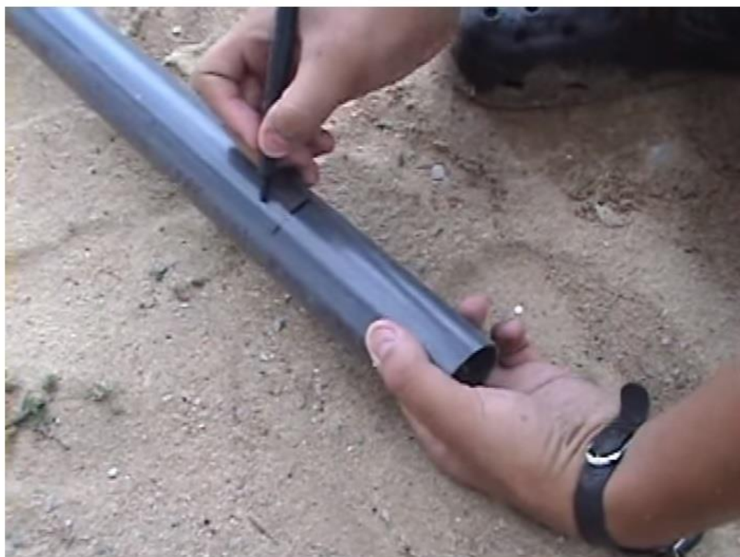
Figura 58: Marcação das ranhuras a serem cortadas por serra manual (Buchner, 2010b)
