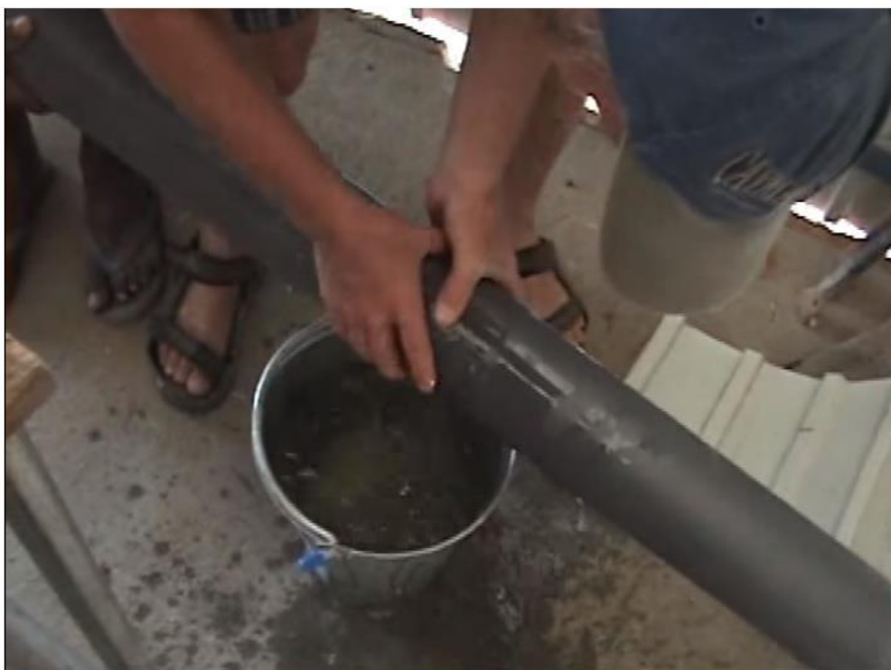
Figura 57: É aplicada água para esfriar o tubo de forma, a partir daqui o encaixe está moldado (Buchner, 2010a)
