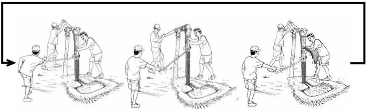
Figura 33: Diagrama da execução de sondagem (Williams, 2014)
