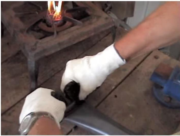
Figura 61: Dobramento da ponta (Buchner, 2010b)
