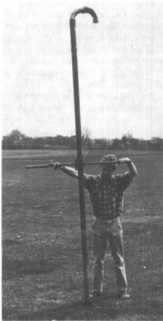
Figura 37: Tubo de sondagem de aço com 50 mm de diâmetro por 3 m de comprimento, com pegas que servem para elevar e baixar durante a sondagem, no topo um cotovelo de 180° (Carter, 1985)
