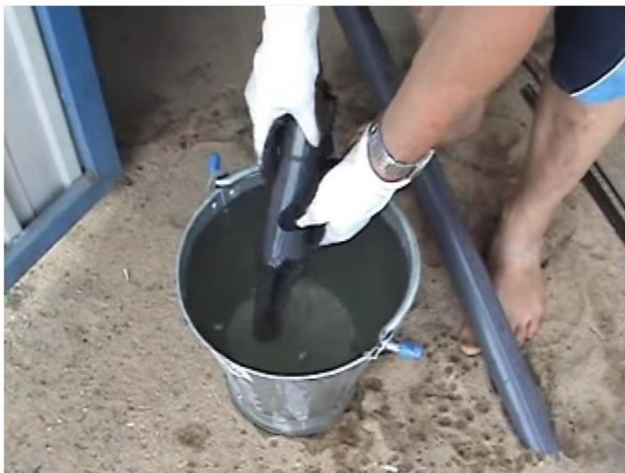
Figura 61: Dobramento da ponta (Buchner, 2010b)
