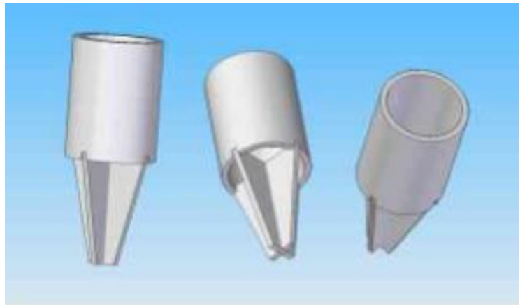
Figura 35: Bit de sondagem usado pela metodologia jetting (Danert, 2009)
