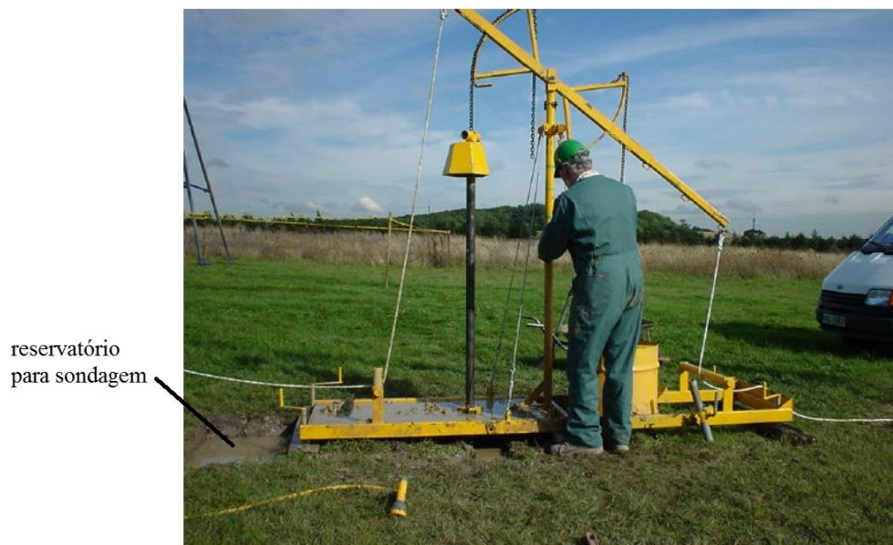
Figura 31: Sondador a efetuar sondagem de teste (Carter, 2001)
