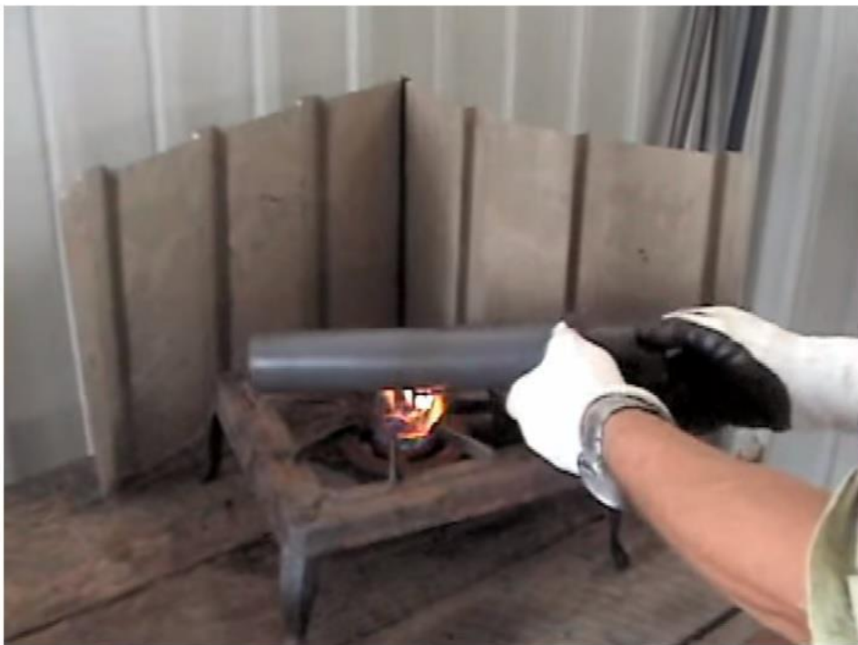
Figura 60: Aquecimento do tubo (Buchner, 2010b)
