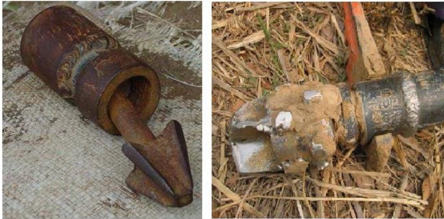
Figura 30: Bits de sondagem, à esquerda, o bit Baptista (Waller, 2008)
