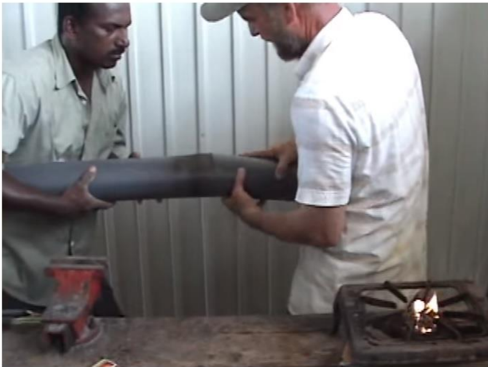
Figura 56: Encaixe forçado com uma peça fria, transformando o topo numa nova forma fêmea (Buchner, 2010a)
