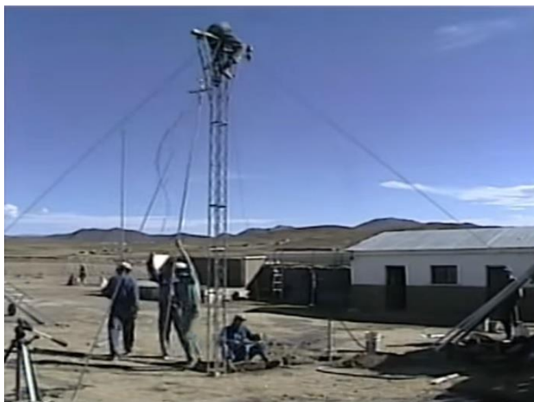
Figura 40: Torre de sondagem do método EMAS (Buchner, 2010c)
