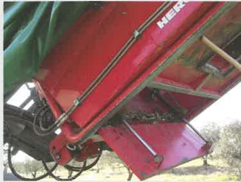
Figura 10 - Porta de descarga do aparafritos
