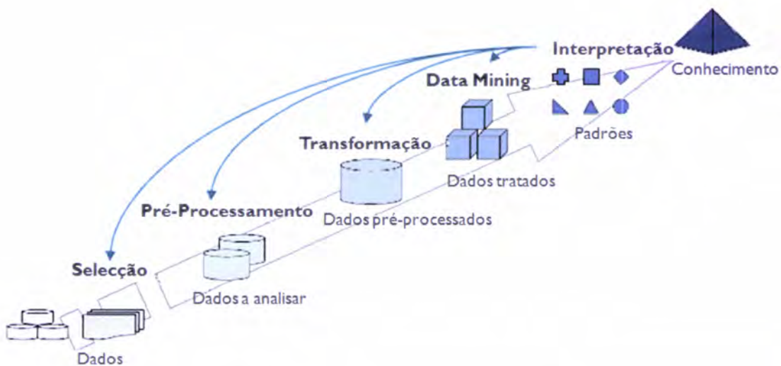
Figura 17 – Processo de descoberta de conhecimento em bases de dados. Adaptado de Santos e Azevedo [Santos & Azevedo, 2005].
