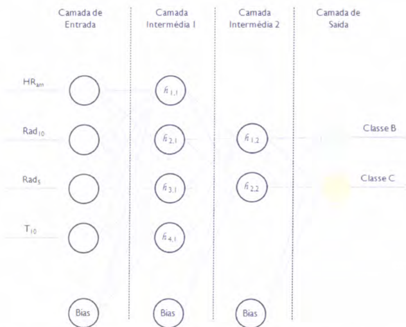
Figura VIII.2 – RNA obtida para previsão da qualidade da água da albufeira de Odivelas, tendo em consideração a utilização de parâmetros meteorológicos e hidrométricos.
