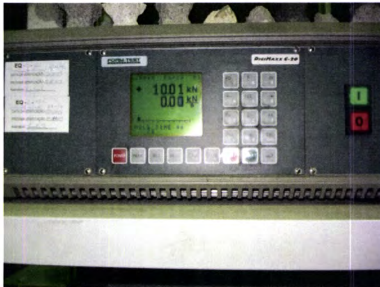
Figura 26 - Equipamento de aplicação de cargas no ensaio do módulo de elasticidade
