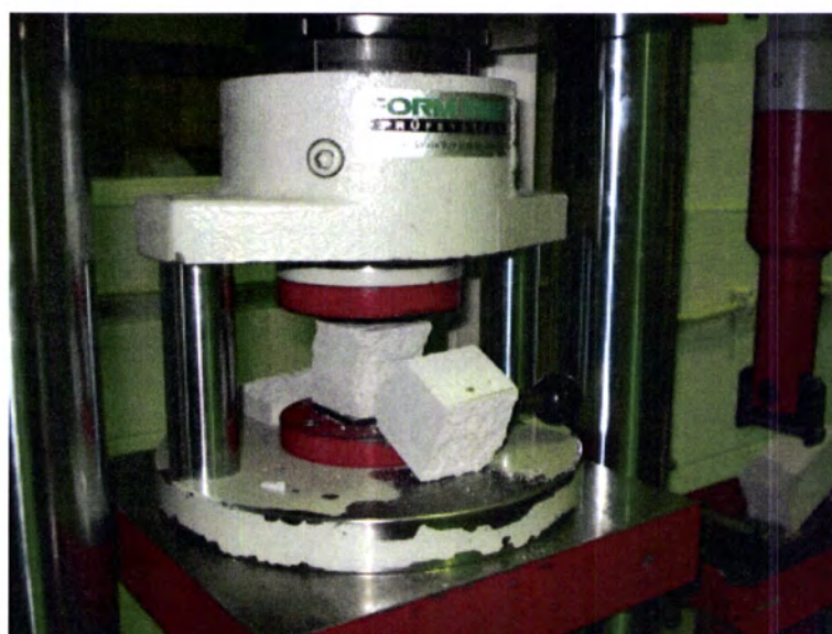
Figura 25 - Ruptura do semi-prisma no ensaio de resistência à compressão
