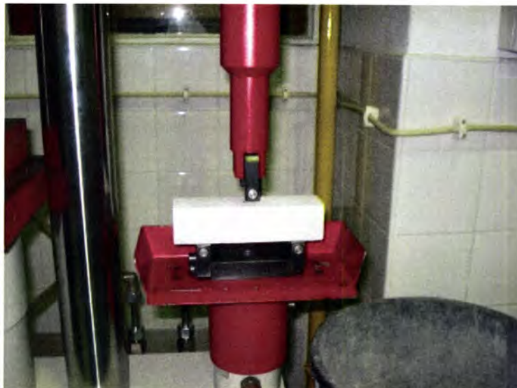
Figura 20 - Início do ensaio de resistência à flexão
