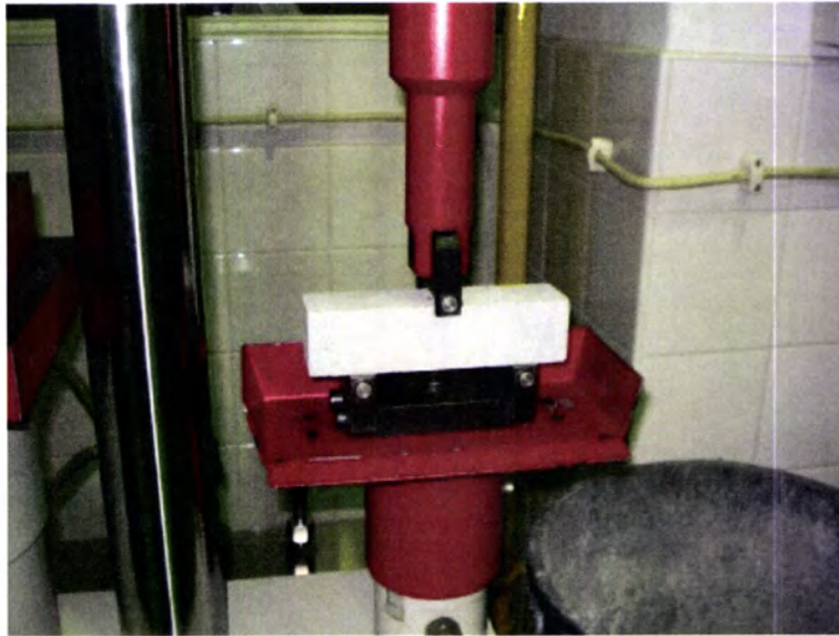
Figura 21 - Carga aplicada no provete no ensaio de resistência à flexão
