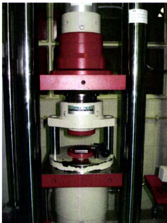
Figura 23 - Aparelho para ensaio de resistência à compressão
