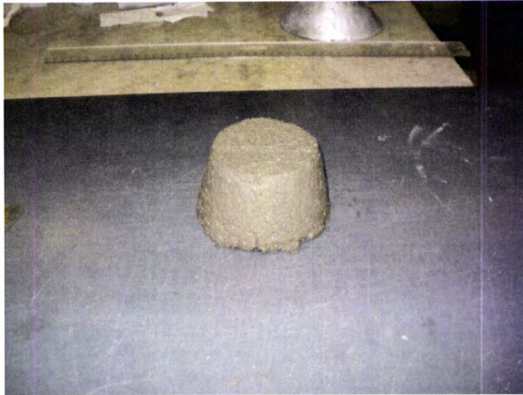
Figura 16 - Argamassa com baixo espalhamento
