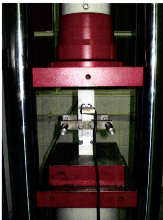
Figura 27 - Provete com instrumentos de medida para o ensaio do módulo de elasticidade
