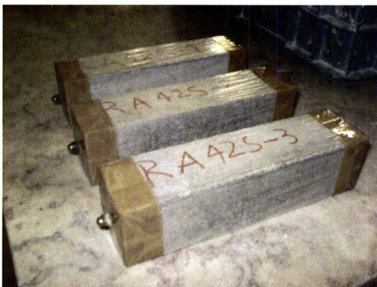
Figura 30 - Provetes para medição da retracção autógena
