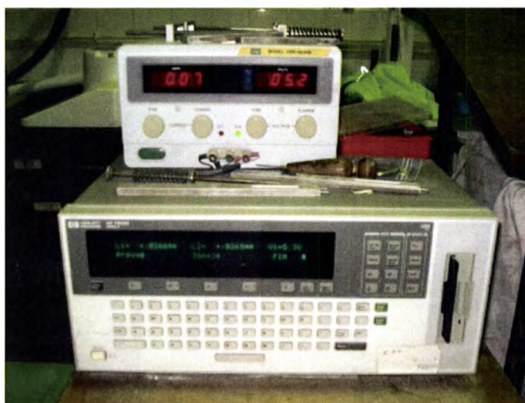
Figura 28 - Equipamento para leitura das extensões incitadas pelo ensaio
