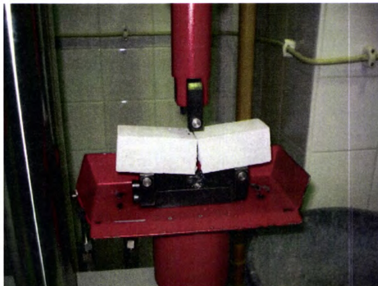
Figura 22 - Ruptura do provete no ensaio de resistência à flexão
