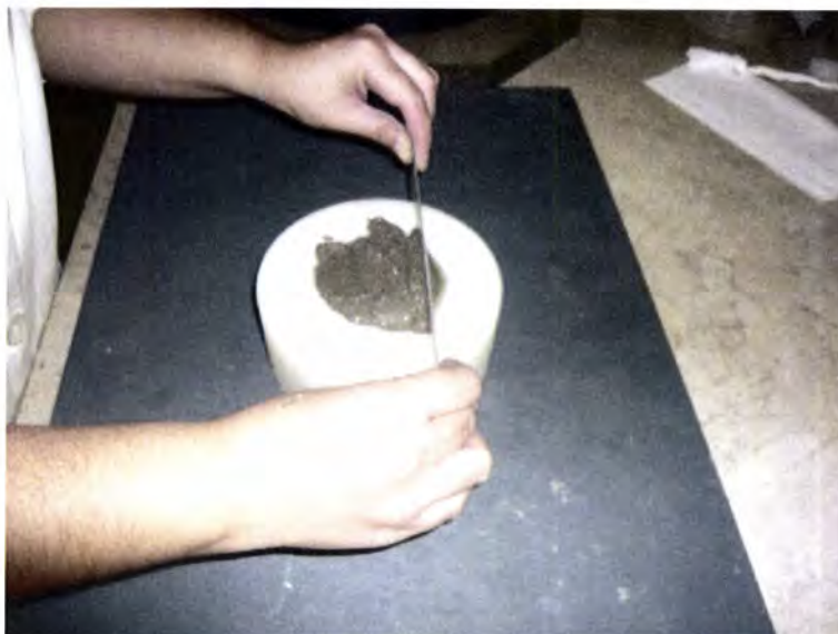
Figura 15 - Alisamento e retiro da argamassa em excesso
