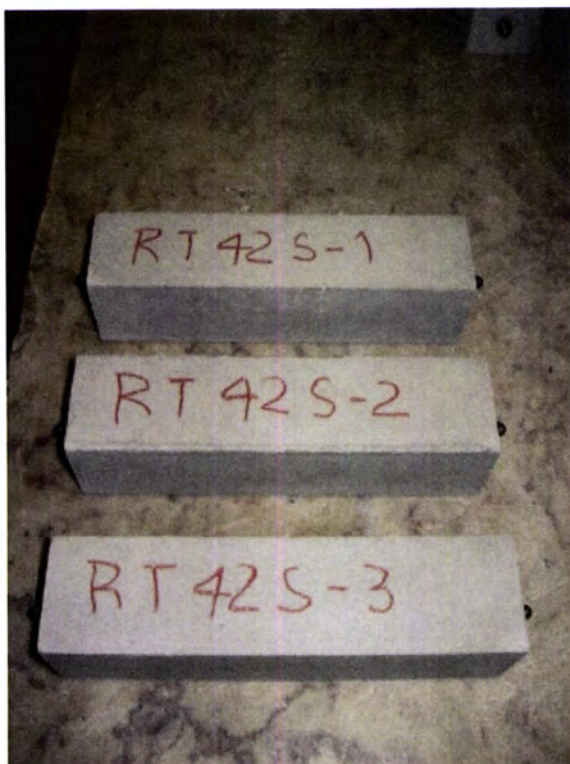
Figura 31 - Provetes para medição da retracção total
