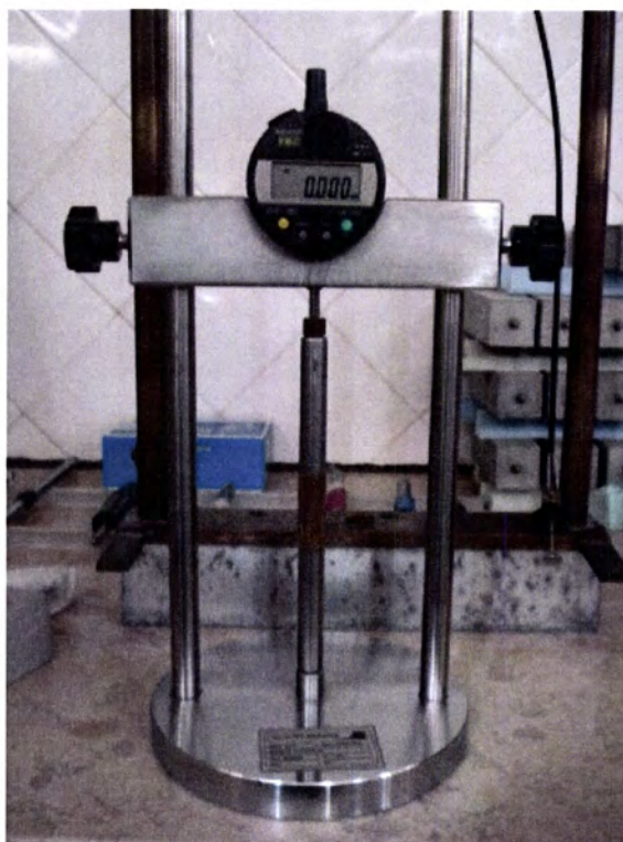
Figura 29 - Equipamento para medição das extensões no ensaio de retracção autógena
