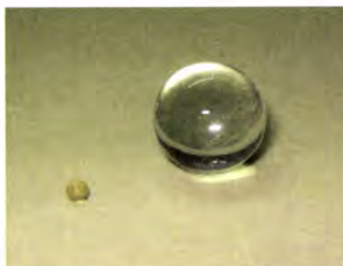
Figura 1 - Representação do efeito da água num polímero superabsorvente: à esquerda no estado seco e à direita no estado expandido, após absorção da água
