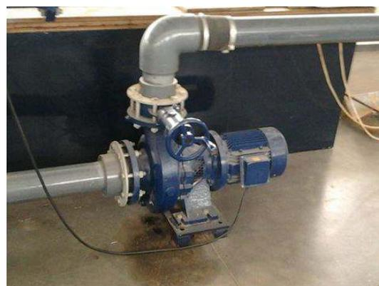
(b) Bomba centrífuga e válvula de borboleta
