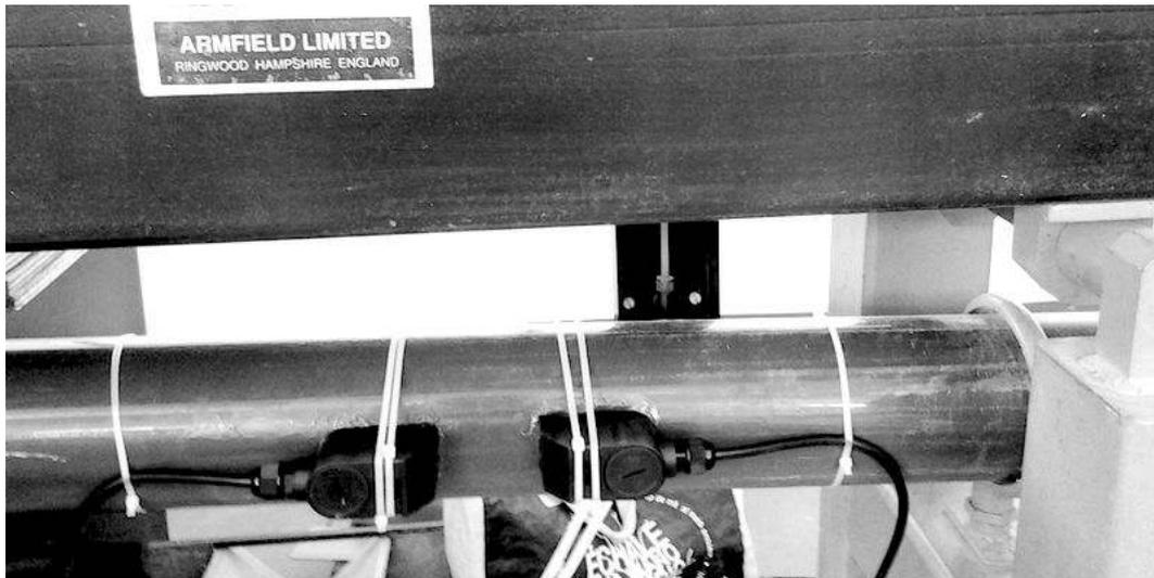
Figura 3.1.8 – Caudalímetro ultrassónico TDS-100M: transdutores ultrassónicos instalados
