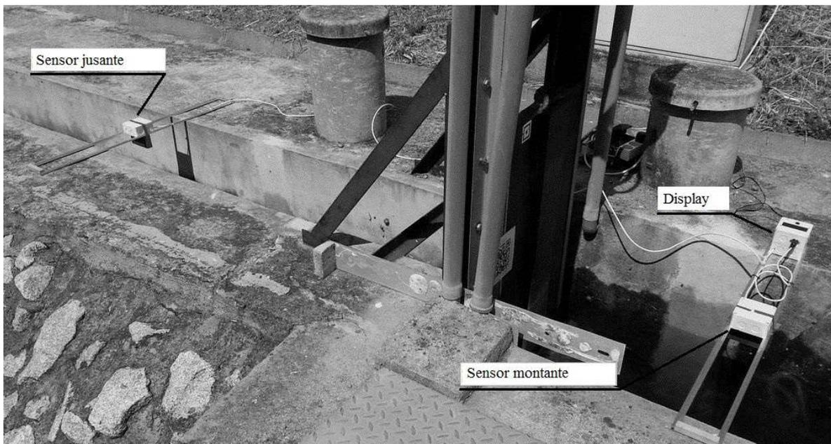
Figura 3.2.4 – Medidor de nível ultrassónico
