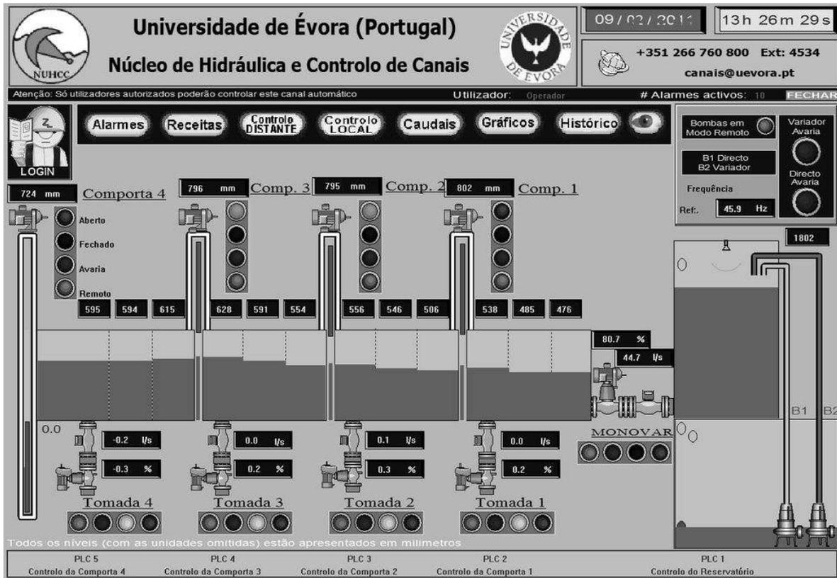
Figura 3.2.2 – Sinóptico SCADA
