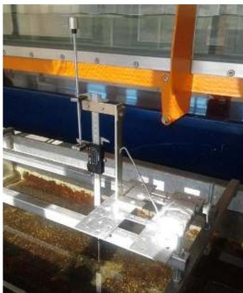
(c) Hidrometro instalado a montante do descarregador triangular
