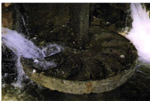
Fig. 17 - Rodízio ou roda horizontal de pedra e de transmissão directa Fig. 18 - Mó andadeira com taco de madeira
