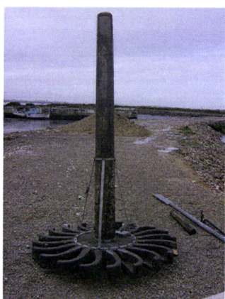
Fig. 56 – Estrutura de um Rodizio em madeira
