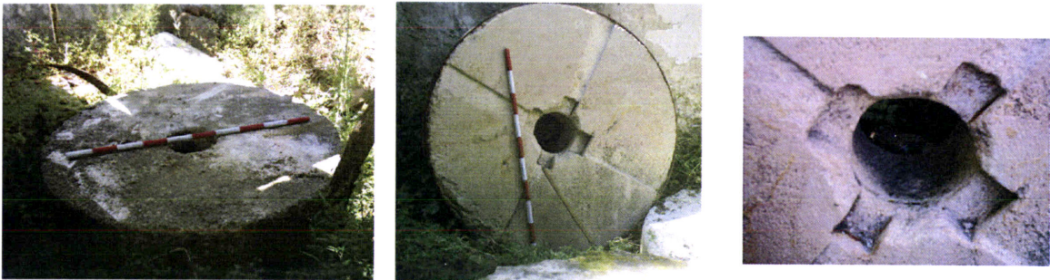
Fig. 60 - Mó pouso de granito, fixa, (figura da esquerda) e mó andadeira (figura do centro), localizam-se nos Moinhos do Mocho e dos Castelos Velhos. A figura da direita representa o olho da mó, buraco e encaixe ao centro das mós andadeiras, onde era introduzida a segurelha que ligava a mó ao veio do eixo do rodízio.
