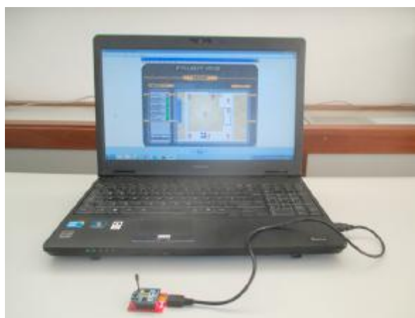
Figura 4.8 – Sistema SCADA centralizado com recetor sem fios.
