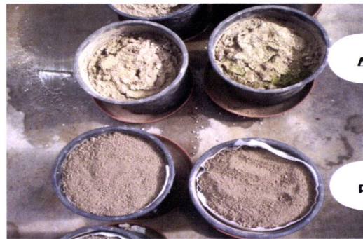
Figura 6 - Representação de vasos com solo não perturbado (A) e com solo crivado (B) (foto da autora, 2013).
