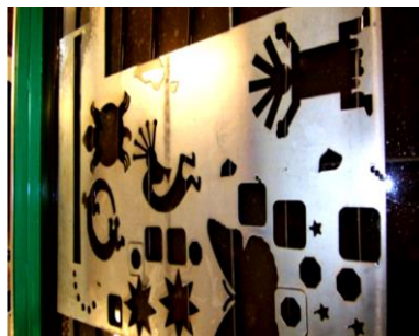
Figura 62 - Exemplo de como o plasma corta superfícies pequenas com precisão e de forma limpa. (GREENCUBE, 2012)
