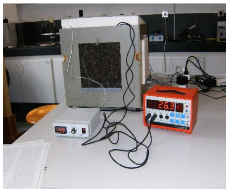
Figura 3.4.2 - Ensaio com glomerado de cortiça expandida, com os termopares e os medidores digitais a registar a temperatura.
