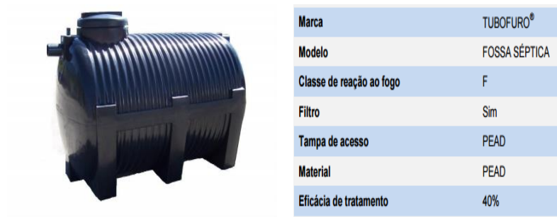
Figura 42 – Imagem de uma Fossa Séptica e respetivas características. (TUBOFURO - Tubos em PVC, S.A)
