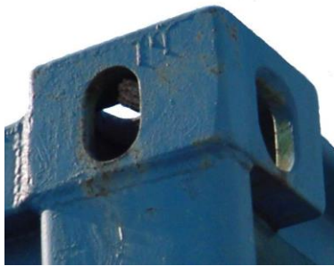
Figura 18 – Peça de canto do contêntor. (COOPER, KILMER, & WANDS, 2003)
