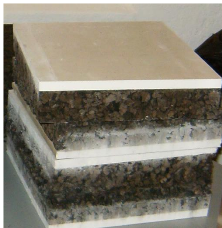
Figura 234 – Amostras das placas Gypcork utilizada na experiência, dadas as duas características, optou-se por utilizar na parte do projeto
