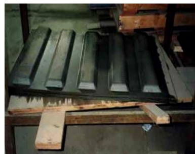
Figura 28 – Nesta imagem pode ver-se “peças” que se podem substituir em caso de corrosão muito profunda e não reparável, neste caso foram para uma reparação na cobertura do contentor. (GREENCUBE, 2012)
