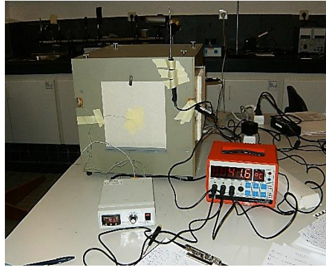
Figura 3.4.4 - Ensaio com Gesso, medidores digitais a registarem as temperaturas interiores e exteriores nos isolamentos, bem como a temperatura ambiente interior e exterior.
