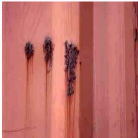
Figura 32 – Exemplo de uma soldadura porosa, tem pequenos furos, logo vai deixar passar humidade e radiação solar. (GREENCUBE, 2012)
