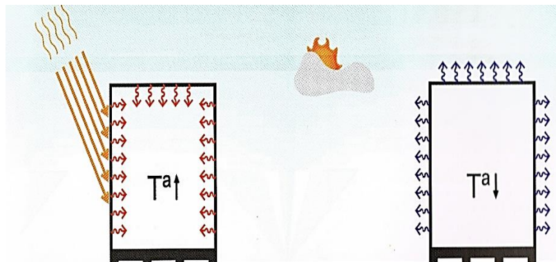
Figura 81 – Os contentores são muito pesados e têm pouco isolamento, ou seja, aquecem rapidamente quando recebem a radiação solar e arrefecem rapidamente durante noite. (GARRIDO, 2011)
