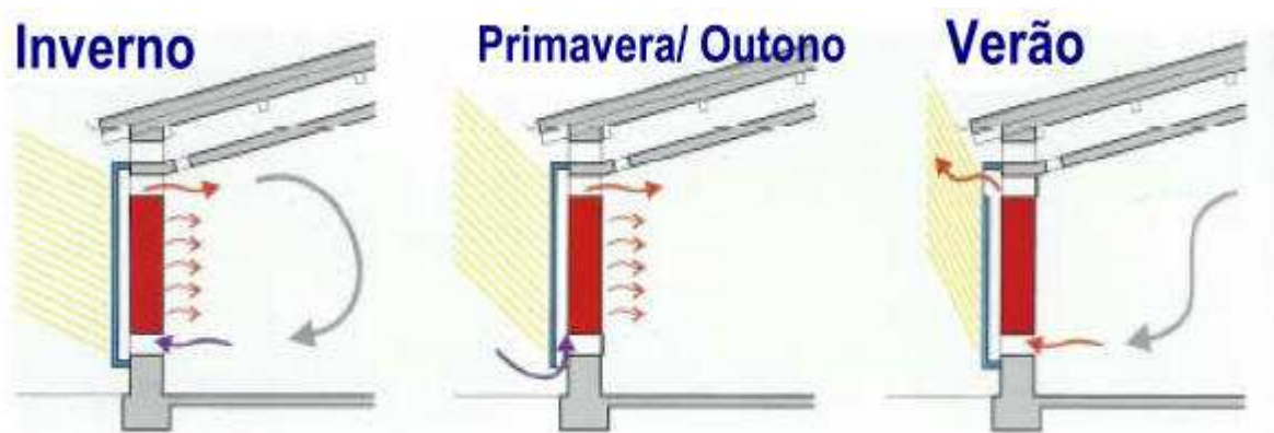
Figura 5. Posicionamento das aberturas da parede de Trombe para as diferentes estações do ano (in[21]).
