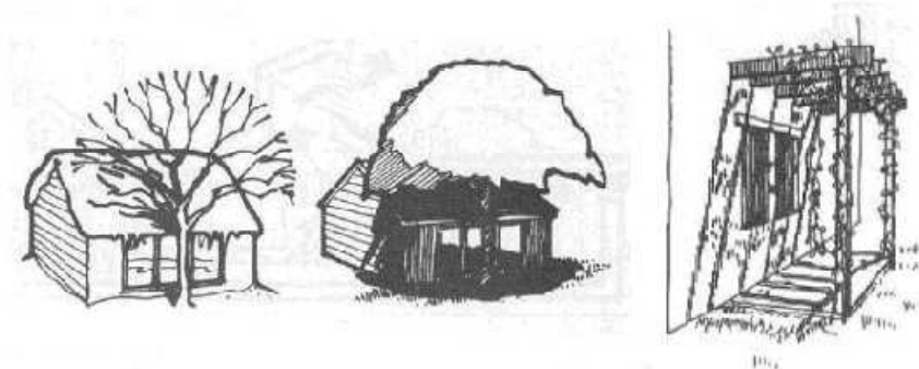
Figura 4. Influência da vegetação no desempenho térmico de fachadas, (in [14]).
