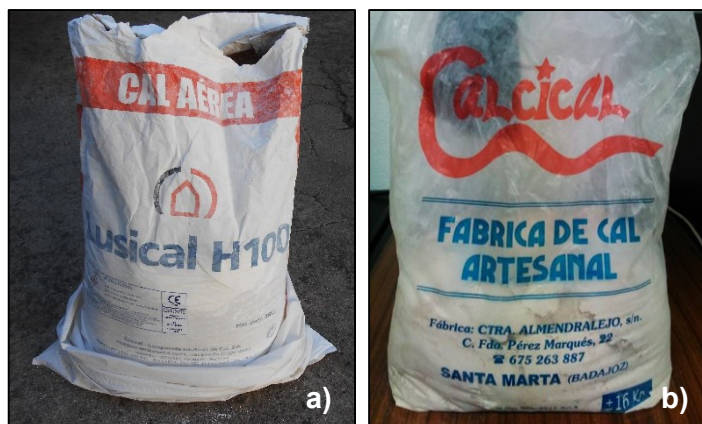
Figura 3.2 – Cais hidratadas utilizadas: a) Calcítica; b) Dolomítica.
