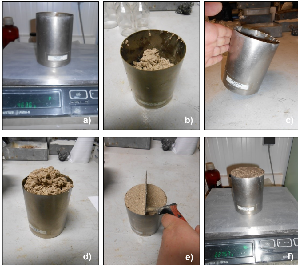
Figura 4.3 – Etapas do ensaio de determinação da massa volúmica aparente das argamassas: a) Pesagem do recipiente vazio; b) Colocação da primeira camada de argamassa no recipiente; c) Compactação da primeira camada de argamassa; d) Colocação da segunda camada de argamassa no recipiente; e) Nivelamento da superfície; f) Pesagem.
