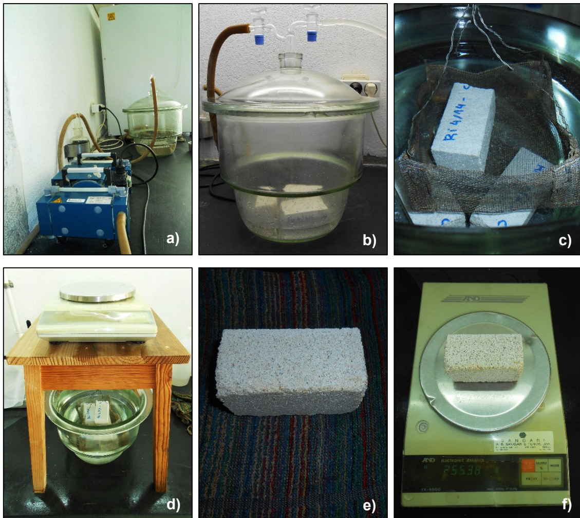
Figura 4.14 – Ensaio de determinação da porosidade aberta das argamassas de cal: a) Bomba de vácuo e exsiccador; b) Colocação de água no exsiccador; c) Cesto onde são colocados os provetes para realizar a pesagem hidrostática; d) Pesagem hidrostática; e) Remoção do excesso de água das faces de um provete; f) Pesagem dos provetes saturados.
