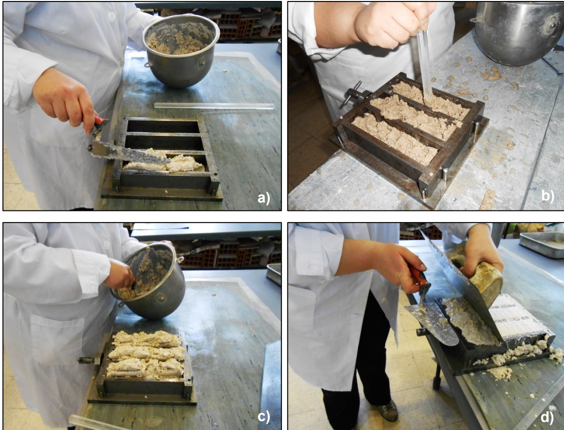
Figura 3.7 – Procedimento de preparação dos provetes de argamassa: a) Colocação da primeira camada de argamassa; b) Compactação manual; c) Colocação da segunda camada de argamassa no molde; d) Nivelamento da superfície dos provetes.
