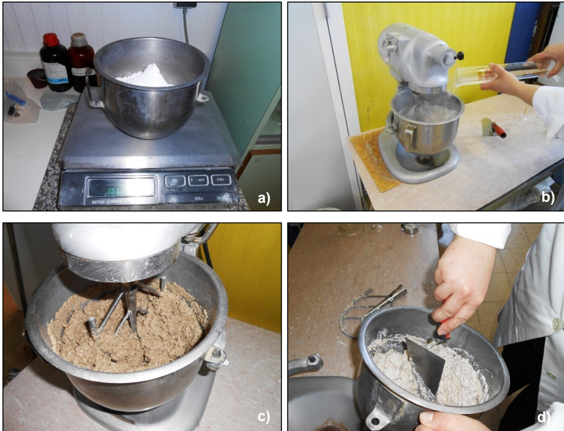
Figura 3.6 – Fases da amassadura de uma argamassa: a) Pesagem dos constituintes; b) Adição de água; c) Mistura mecânica dos constituintes; d) Remoção do material que aderiu às paredes da cuba.
