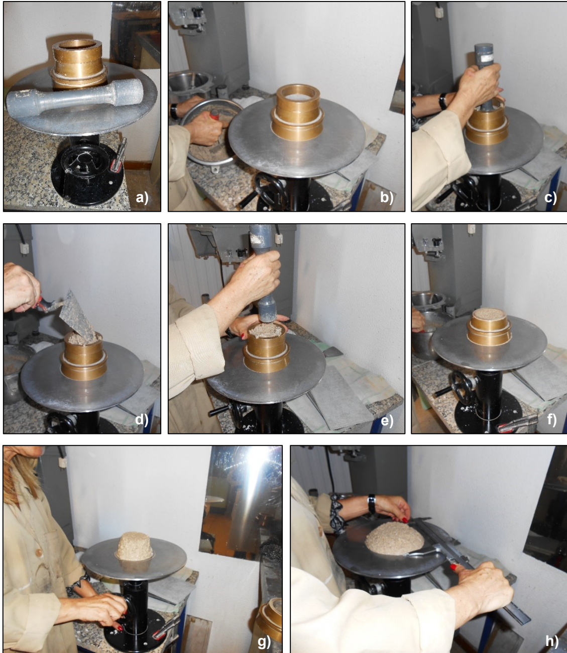
Figura 4.2 – Etapas do ensaio de determinação da consistência por espalhamento: a) Mesa de espalhamento; b) Colocação da primeira camada de argamassa; c) Compactação da primeira camada; d) Colocação da segunda camada de argamassa; e) Compactação da segunda camada; f) Nivelamento da superfície; g) Espalhamento da argamassa; h) Medição do diâmetro.
