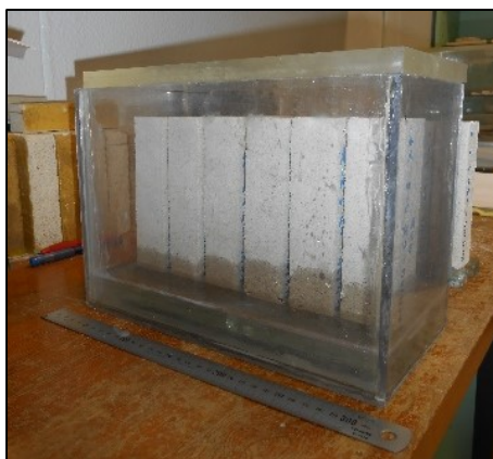
Figura 5.11 – Evolução da frente de ascensão capilar nas argamassas CD (180 dias) ao longo do ensaio de absorção de água por capilaridade.
