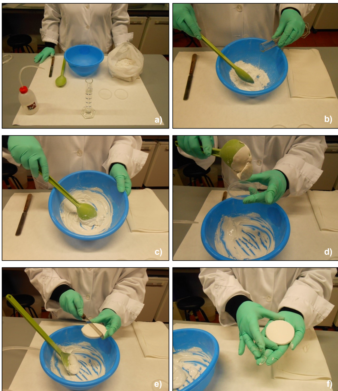
Figura 3.12 – Preparação dos provetes de pasta de cal: a) Preparação dos materiais e utensílios; b) Adição de água à cal; c) Mistura dos constituintes; d) Colocação da pasta de cal no molde; e) Nivelamento da superfície; f) Provede de cal, depois de removidas as bolhas de ar.
