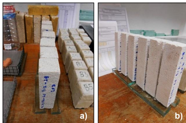
Figura 4.12 – Ensaio de secagem dos provetes de argamassa: a) Vista frontal; b) Vista lateral.
