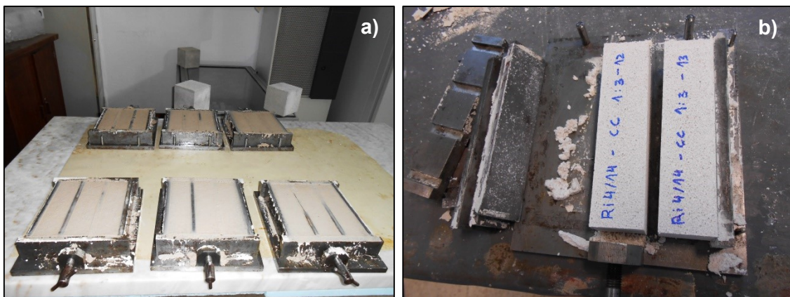
Figura 3.8 – Cura e desmoldagem dos provetes de argamassa: a) Colocação dos provetes na sala de cura; b) Desmontagem dos moldes para remoção dos provetes.
