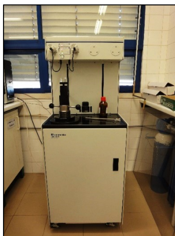
Figura 4.8 – Equipamento utilizado na análise de porosimetria por intrusão de mercúrio (imagem cedida pelo Laboratório de análises da Requimte).
