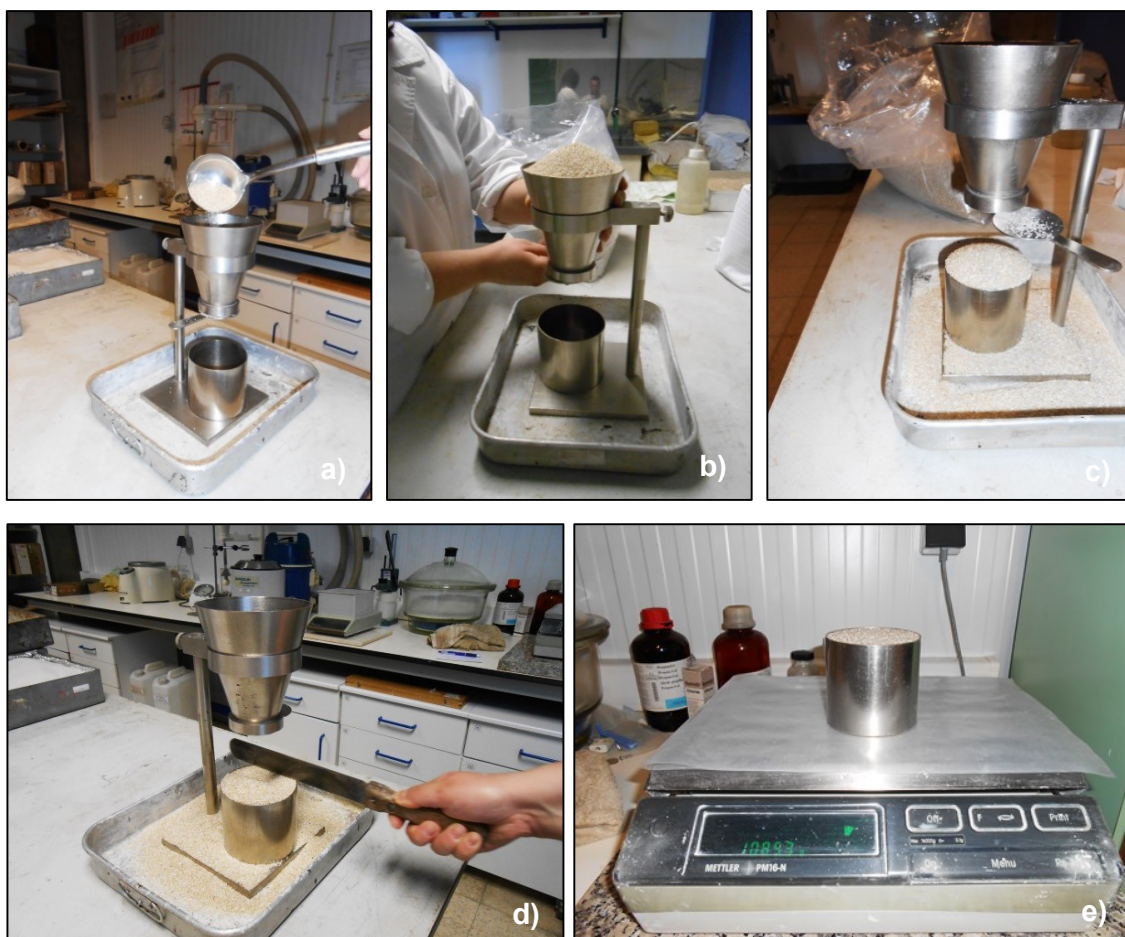
Figura 4.1 – Etapas do ensaio de determinação da massa volúmica aparente dos constituintes secos das argamassas: a) Colocação do material no molde tronco-cônico; b) Abertura do obturador; c) Descida do material para dentro do recipiente; d) Nivelamento da superfície; e) Pesagem do material.
