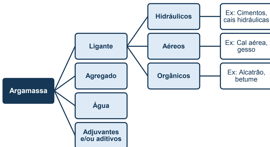
Figura 2.4 – Esquema representativo dos constituintes das argamassas.
