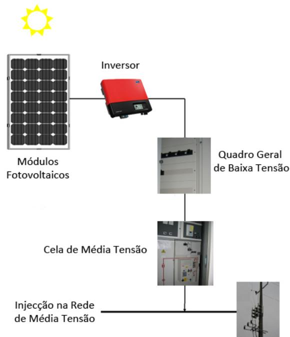
Figura 15 – Esquema de ligação de uma central fotovoltaica à rede pública.
