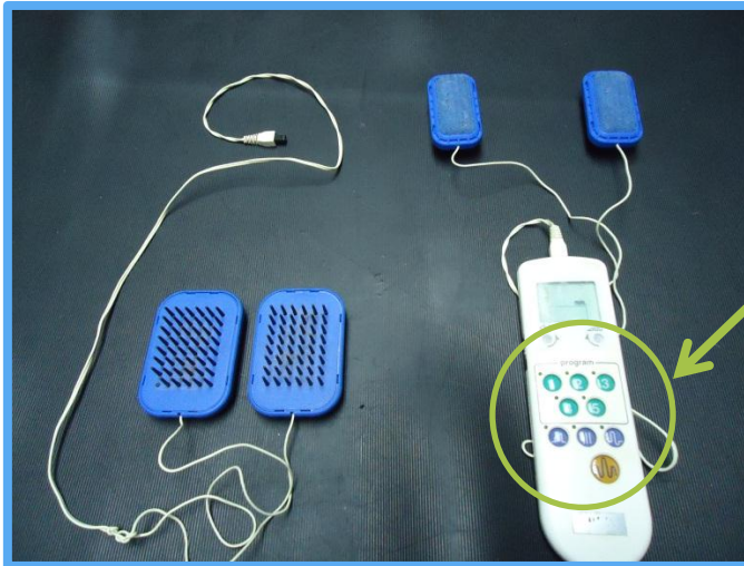
IMAGEM 33: IMAGEM DE UM APARELHO DE TENS PT2000, CONCEBIDO ESPECIALMENTE PARA MEDICINA VETERINÁRIA
