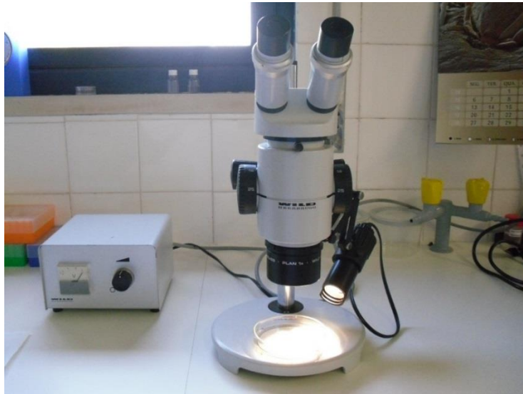
Figura 20 - Microscópio estereoscópio para observação de ovos
