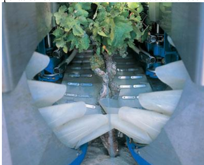
Fig. 1.22 – Godés fechando-se em torno de uma cepa. http://www.newholland.com/
