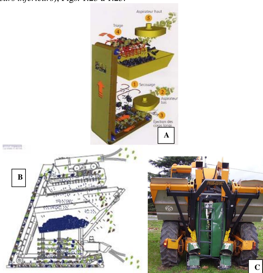
Fig. 1.23 – (A) Extractores de limpeza superior e inferior (do lado esquerdo); (B) Vista lateral mostrando o posicionamento dos extractores superior e inferior; (C) Saída dos extractores superiores e inferiores na traseira da máquina. http://www.pellenc.com/
