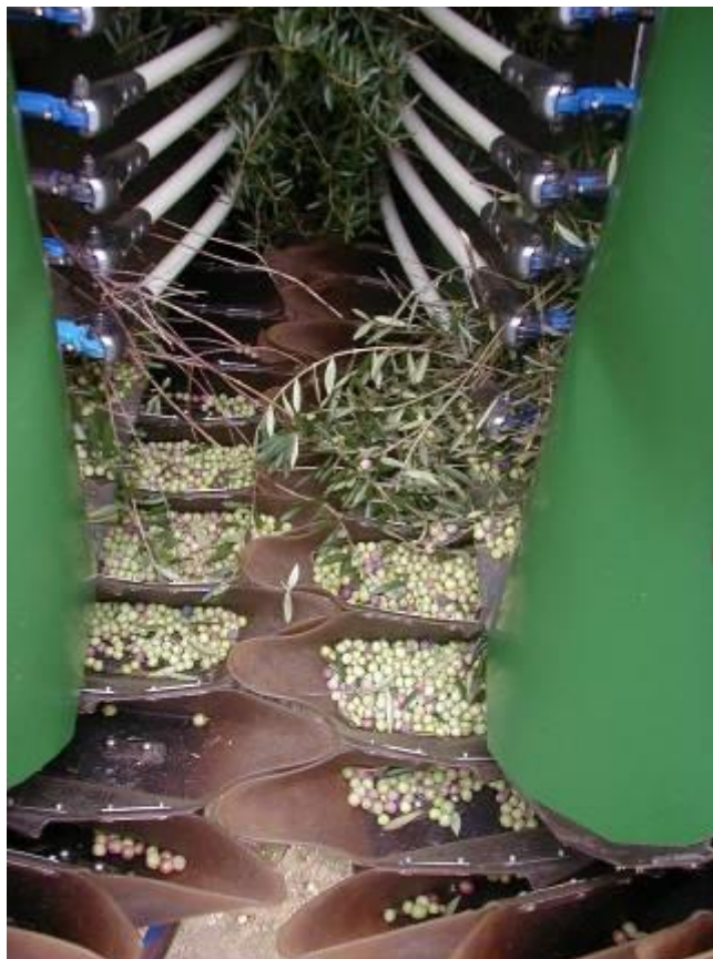
Fig. 1.21 - Transportador contínuo de godés deformáveis Máquina Braud New Holland na Quinta de Vale de Lobos (Ribatejo)
