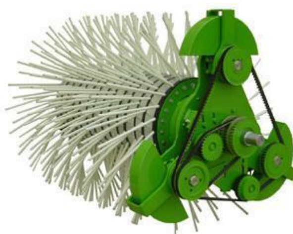
Fig. 2.9 – “Escovas” para separação do tomate da rama
