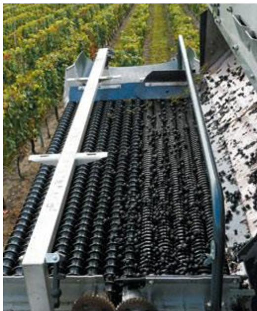
Fig. 1.26 – crivo de roletes para limpeza http://www.pellenc.com/
