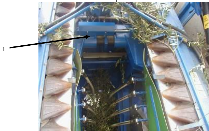
1 – Cilindro hidráulico para regular folga entre os corpos da máquina de vindimar Fig. 1.14 – Máquina Braud New Holland na Quinta de Vale de Lobos (Ribatejo) 2003
