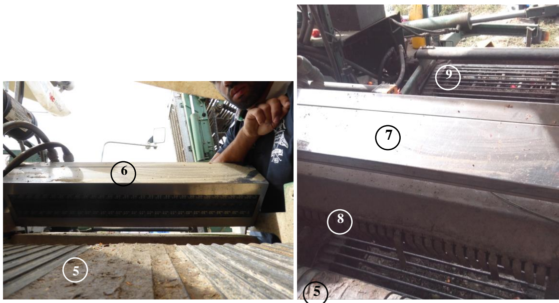
Fig. 2.18 e fig. 2.19 – Imagem do sensor/actuador do segundo estágio de selecção numa máquina MTS-Sandet. Herdade do Falcão (Évora) - 2014
