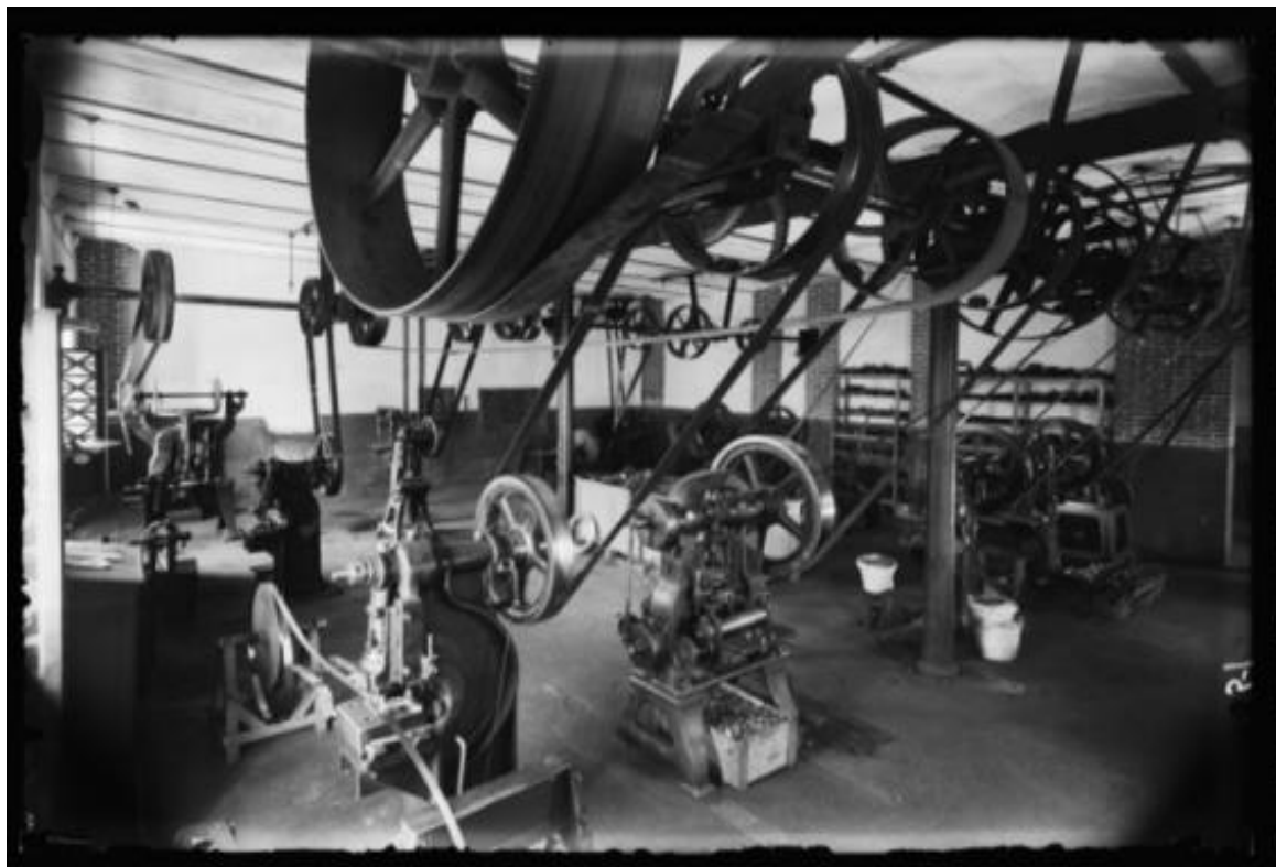
Fig.54 - Pavilhão fabril onde as máquinas são acionadas por motor hidráulico ou térmico.
