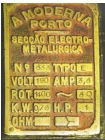
Fig. 66 - Placa de um motor produzido pel' A Moderna - Secção Electro-metalúrgica. Pertencia a um motor com 1 HP com uma r.p.m. de 1400-50 e 0,76 kW.
