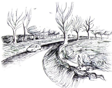
Fig. 2.1.5.5-6 – Ilustração da solução **e** – Um pequeno acréscimo da faixa de expropriação (que neste caso já será, provavelmente, no extremo da propriedade, já que o limite é o coroamento do talude).
